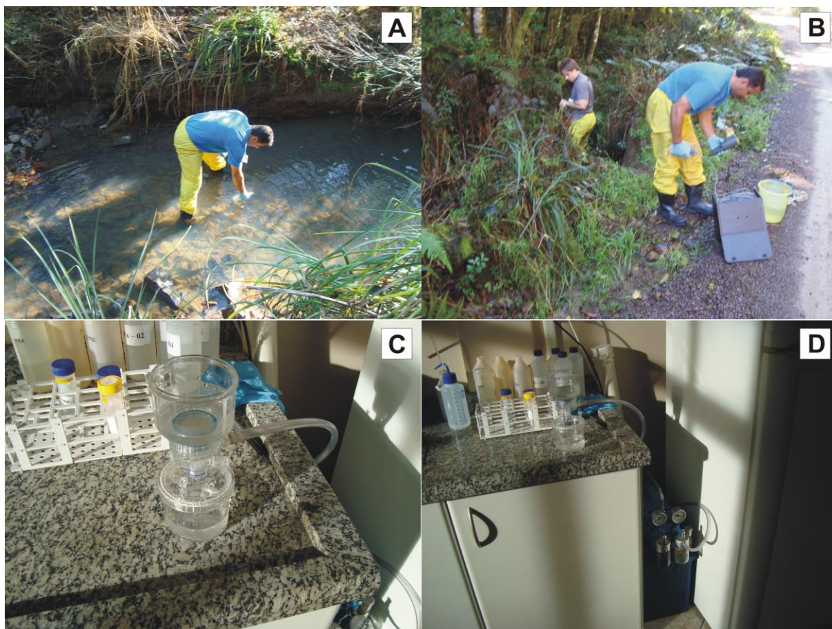
Figura 13. Coleta de água no leito dos tributários estudados e filtragem a vácuo.
