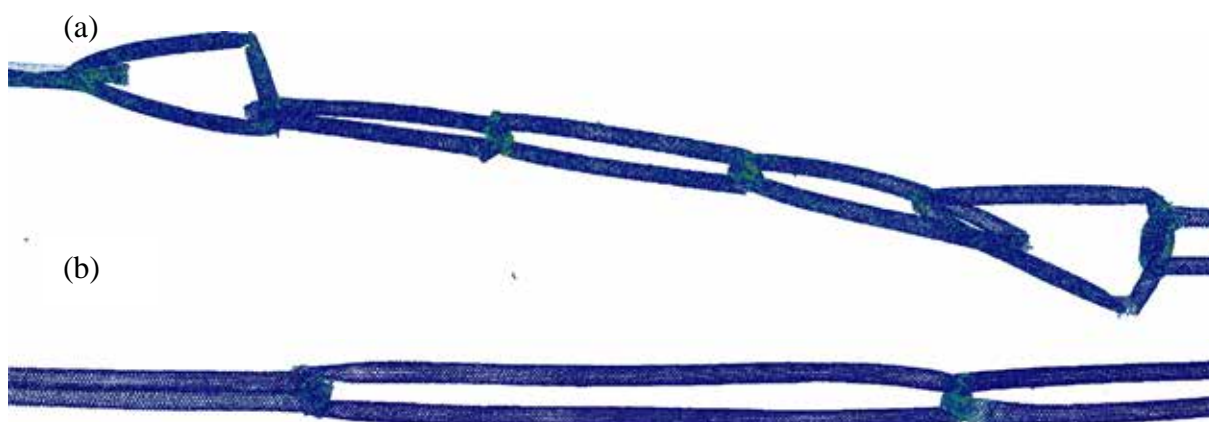
Figura 4.15 – (a) Corrente 10102 e (b) 10104 previamente à fratura. Os átomos são coloridos pela tensão de von Mises.
