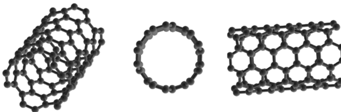
Figura 2.5 – Estrutura atômica de um nanotubo de carbono em diferentes perspectivas
