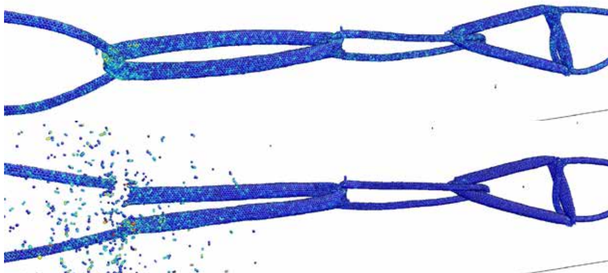
Figura 4.17 – Estrutura da corrente 55210102 antes da fratura, onde a diferença de diâmetros leva a falhas irreversíveis.
