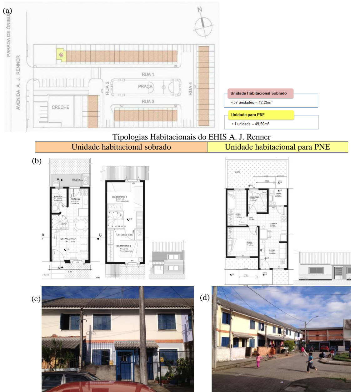
Figura 2 - (a) Representação da implantação do EHS A. J. Renner; (b) tipologias habitacionais; e (c) e (d) fotos
