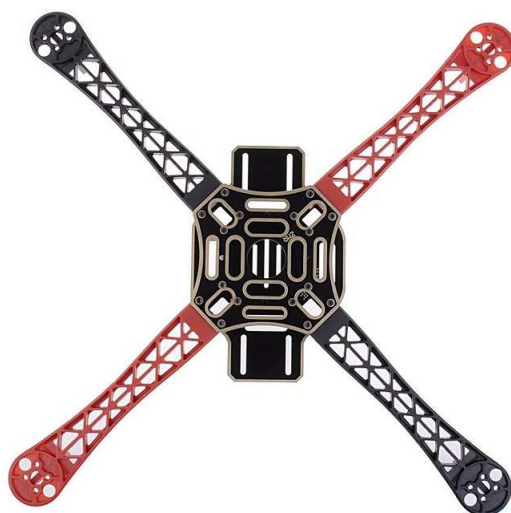
Figura 31: Frame do quadricóptero utilizado para os experimentos práticos (HOBBY-KING.COM, ???).
