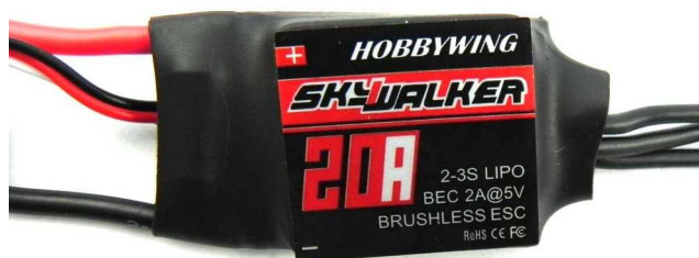
Figura 34: ESC utilizado para controle de velocidade dos motores do quadricóptero (ISEE-ROBOT.COM, ???).
