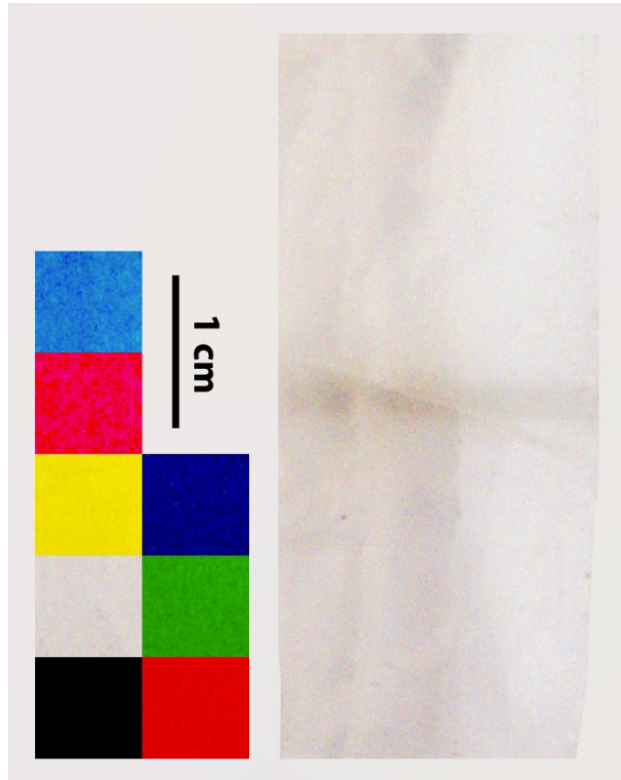
Figura 44 - Irradiação gama seletiva com fresta de 3 mm no quartzo rosa de Águas Vermelhas, MG. Atenuação de chumbo de 10 cm de espessura e dose de 10KGy.
