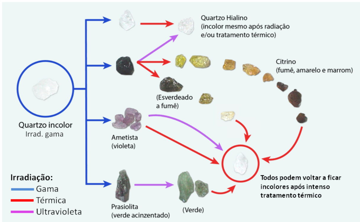
Figura 3 – Possíveis resultados da irradiação gemológica. Irradiação gama (seta azul) em quartzo incolor, em comunhão com a irradiação térmica (seta vermelha) e UV (seta lilás).
