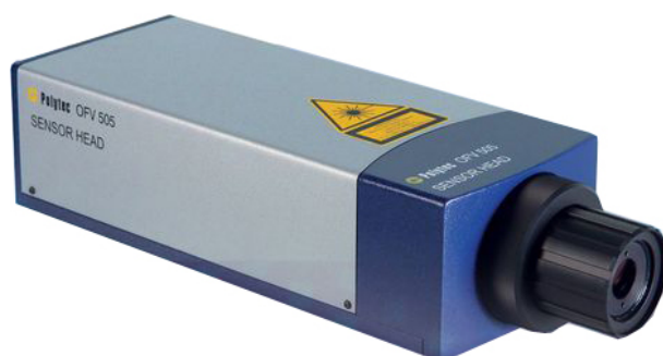
Figura 4.1 – “Cabeça” do vibrometro Polytec utilizado no presente trabalho, imagem extraída do site da Polytec. O esquema de funcionamento é mostrado na figura ?? do anexo F
