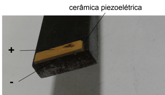
Figura 4.4 – Cerâmica piezoelétrica acoplada a haste metálica, os sinais + - indicam a aplicação da diferença de potencial elétrico.
