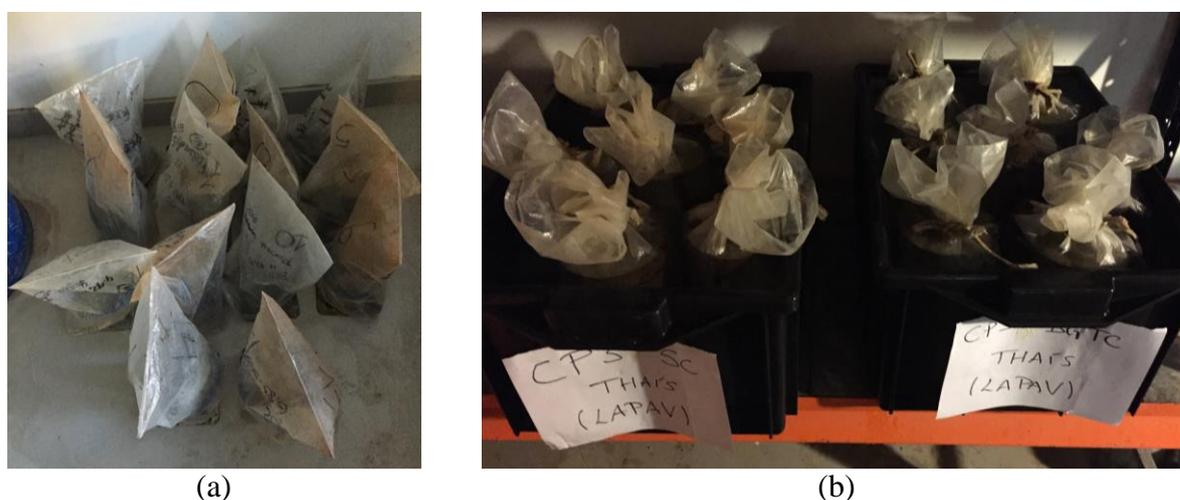
Figura 9: Acondicionamento dos corpos de prova (a) antes e (b) depois da desmoldagem
