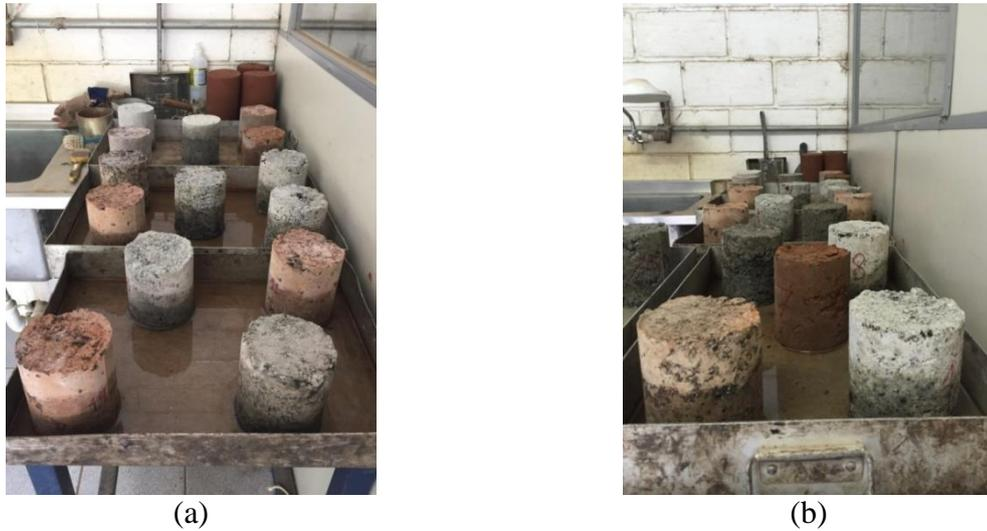
Figura 17: Ensaio de ascensão capilar, expansão e absorção - exposição à água dos CPs pelo período de (a) 24 horas e (b) 72 horas
