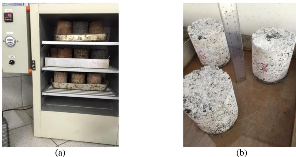
Figura 16: Ensaio de ascensão capilar, expansão e absorção - (a) secagem dos CPs em estufa a 60°C e (b) colocação dos CPs em lâmina d'água de 1 cm
