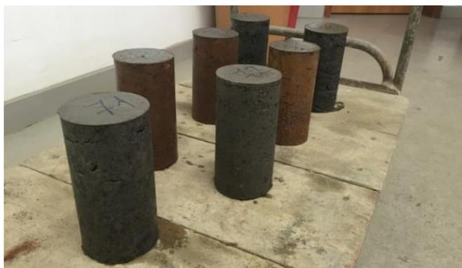
Figura 10: Corpos de prova antes do ensaio de RCS
