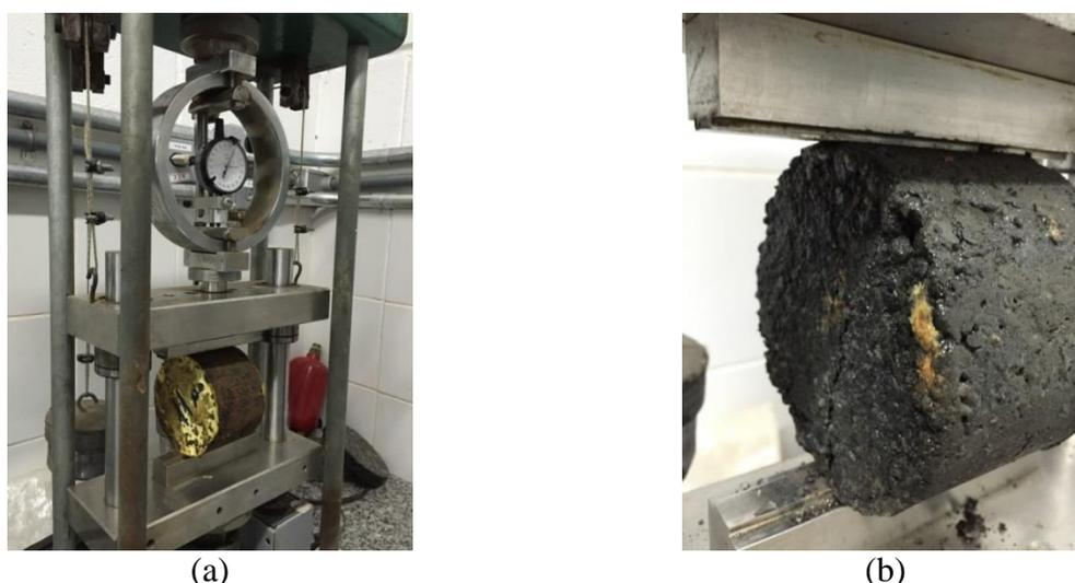
Figura 13: Ensaio de RCD - (a) posicionamento do corpo de prova na prensa (SC) e (b) corpo de prova depois de ensaiado (BGTC)
