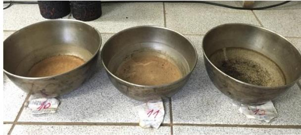
Figura 20: Aparência do material desprendido durante ensaio de erodibilidade
