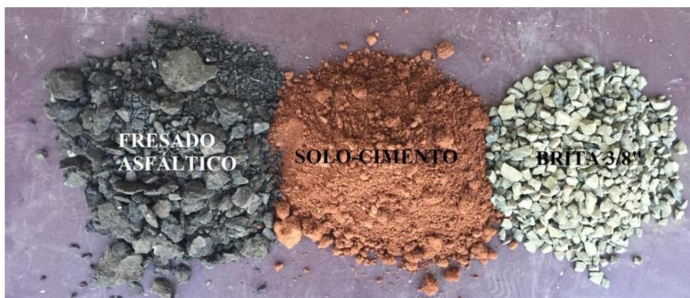
Figura 6: Materiais empregados nas misturas contendo solo-cimento
