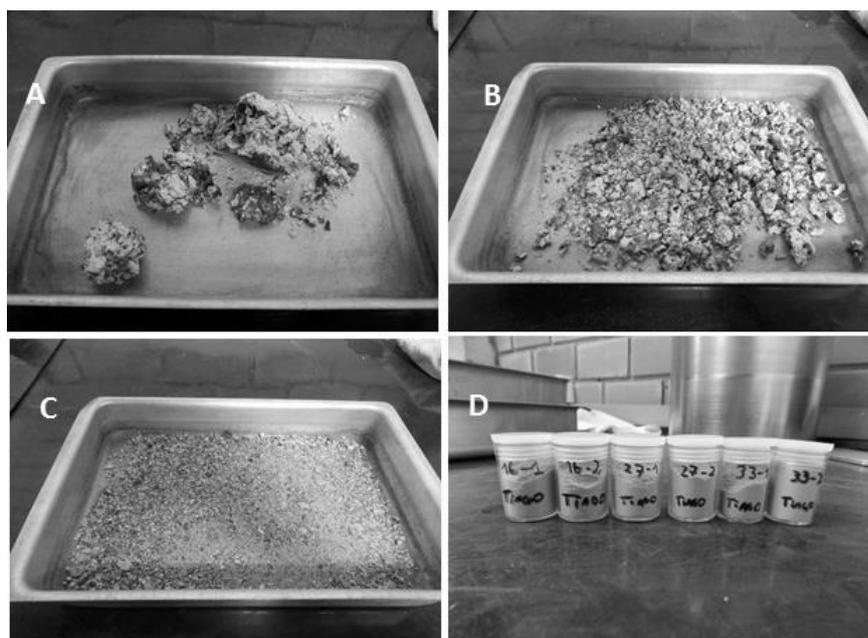
Figura 12 – Transformação Granulométrica das Amostras de Escória.
