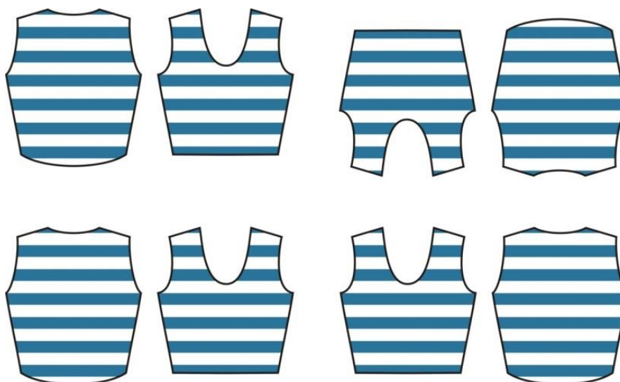
Figura 9 – Encaixe do molde da frente de uma blusa em tecido listrado horizontal simétrico
