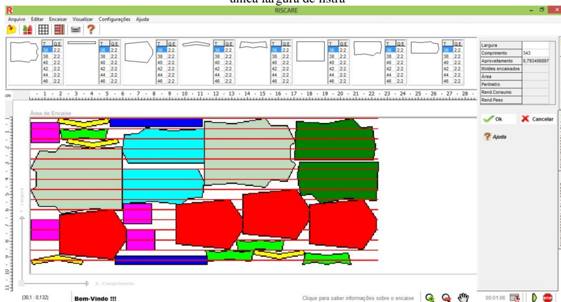
Figura 133 – Encaixe no Riscare Listrado do problema Albano para módulo com listra vertical e uma única largura de listra
