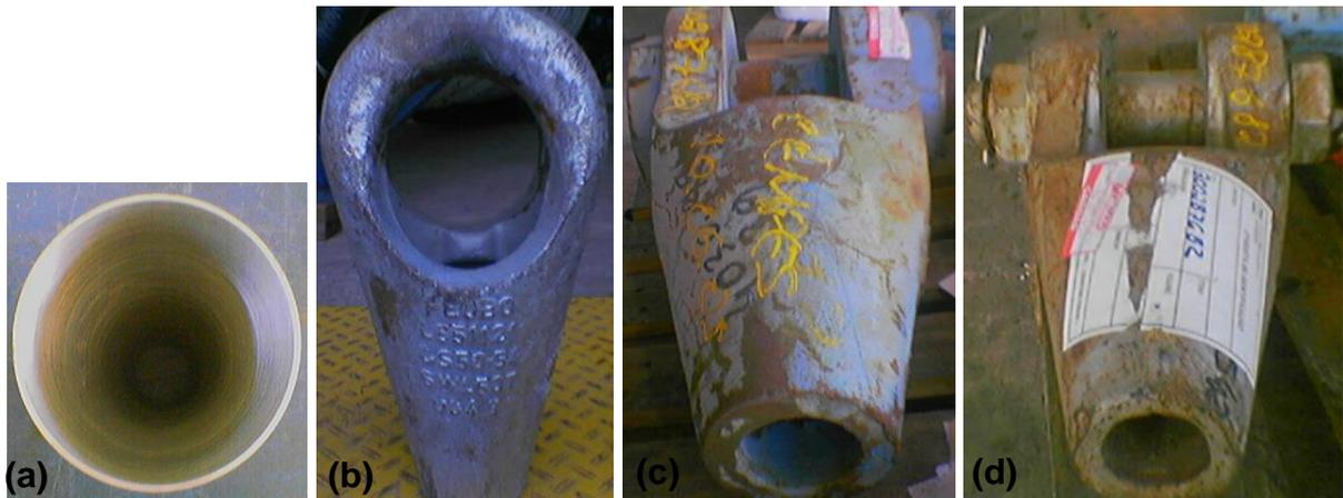
Figura 22: Fotografia dos soquetes (a) menor (vista superior), (b) intermediário, (c) maior A e (d) maior B, utilizados na soquetagem de cabos de 48 mm.
