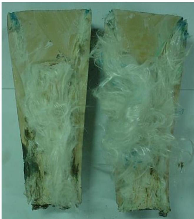
Figura 49: Seção longitudinal da resina 1457+850 do interior do soquete menor após ensaio mecânico do cabo de PET de 48 mm soquetado.
