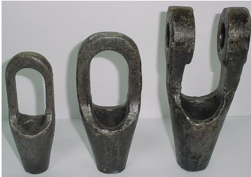
**Figura 21: Fotografia dos soquetes menor, intermediário e maior, respectivamente, utilizados na soquetagem de cabos de 10 mm.**
