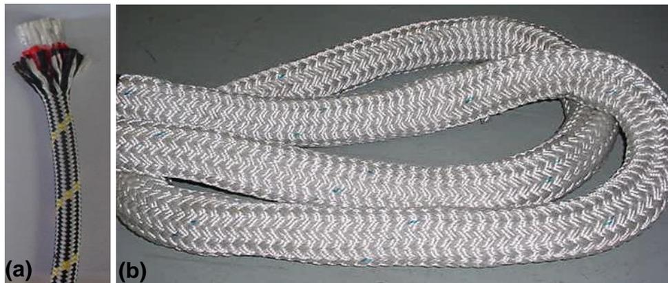
Figura 19: Fotografia dos cabos com diâmetro de (a) 10 mm e (b) 48 mm.
