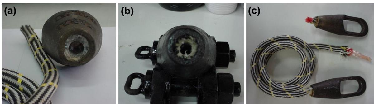
**Figura 45: Fotografias após ensaio mecânico de cabos de PET de 10 mm soquetados com resina (a) 1109+837, (b) Wirelock e (c) 1109+2969.**
