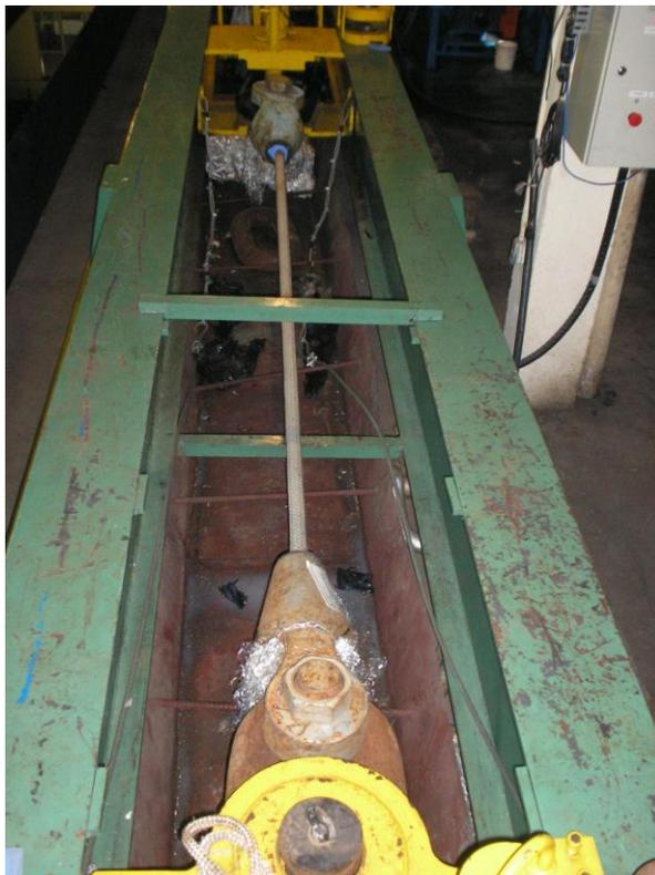
Figura 48: Ensaio mecânico na máquina MT3 na CSL do cabo de PET de 48 mm soquetado.
