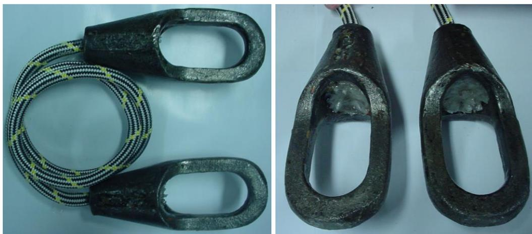
Figura 44: Fotografias de cabos de PET de 10 mm soquetados com soquete intermediário.
