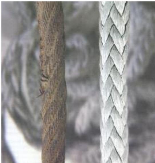
Figura 1: Cabo de aço e de fibra poliéster após utilização em aplicação marítima [17].
