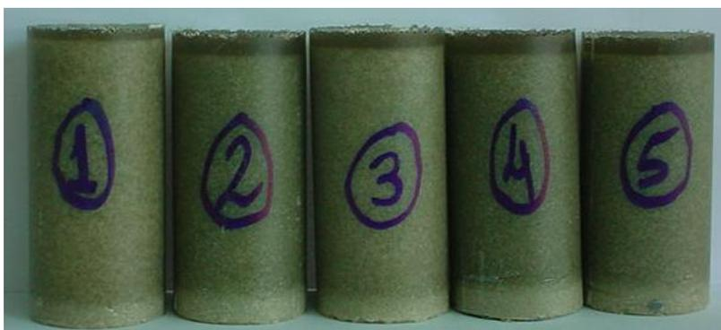
Figura 43: Cp's para o teste de compressão da resina Wirelock.
