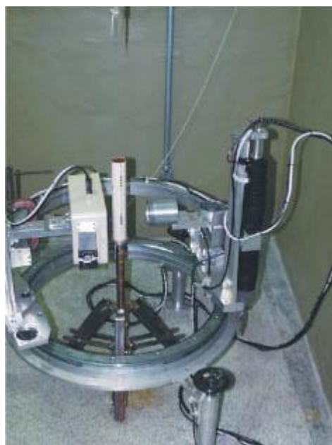
Figura 4 Tomógrafo realizando varredura de amostra de solo (NAIME, 2001)
