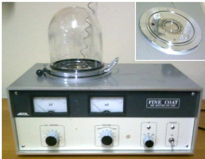
**Figura 100:** Imagem do equipamento Ion Sputter JFC-1100 (JEOL).
