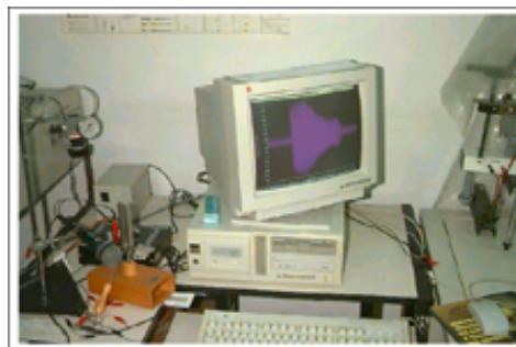
Fig. 2 – Análise de sons produzidos por diapasão (nota musical Lá padrão = 440 Hz), gaita de boca e voz humana, com captação de sinal via microfone conectado a um conversor A/D. Processamento de dados via software SAD 2
