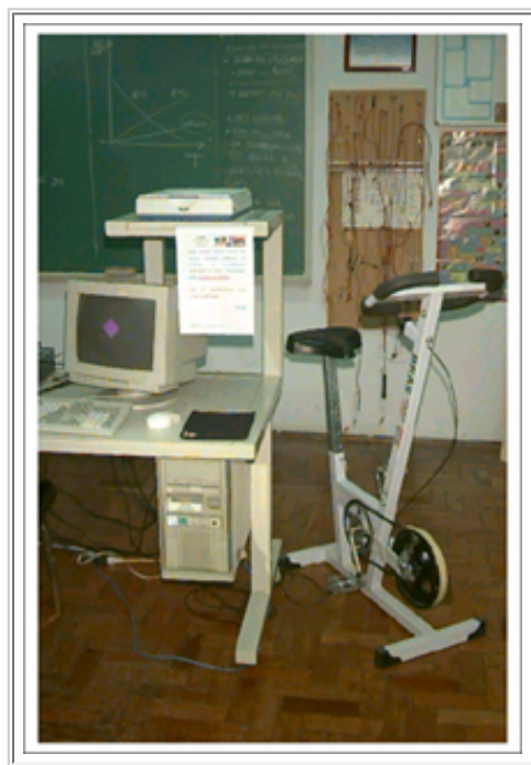
Fig.1 – Bicicleta ergométrica na qual foi adaptada uma célula de carga com strain gages no pedal para medir forças verticais e horizontais. Os strain gages estão conectados a um condicionador de sinais que por sua vez está conectado a um conversor A/D, instalado dentro do computador.
