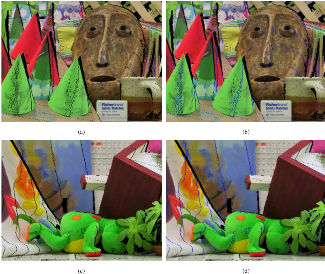
Figura 4.1: Resultados obtidos com o método de detecção dos cracks vazios. (a) Imagem do dataset Cones depois do processo de projeção (região sem informação em preto); (b) Resultado obtido com o método proposto, com os pontos detectados indicados em azul; (c) Imagem do dataset Teddy projetada; (d) Cracks vazios identificados em azul.
