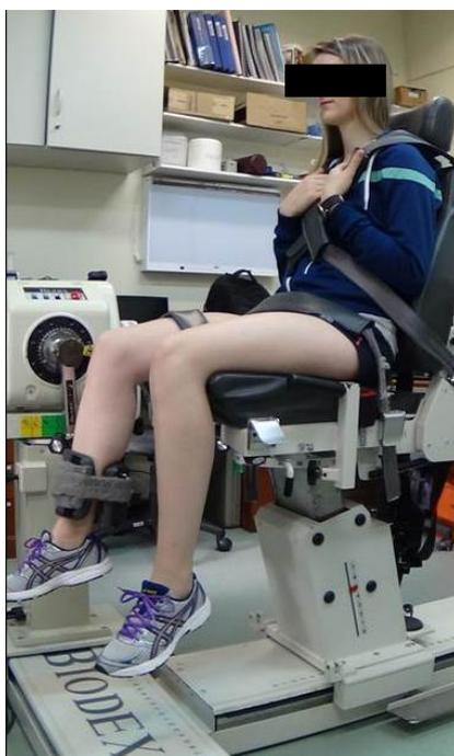
**FIGURA 4.** Dinamômetro Isocinético Biodex 3 System Pro utilizado para a avaliação do torque extensor do joelho durante o protocolo de IM.
