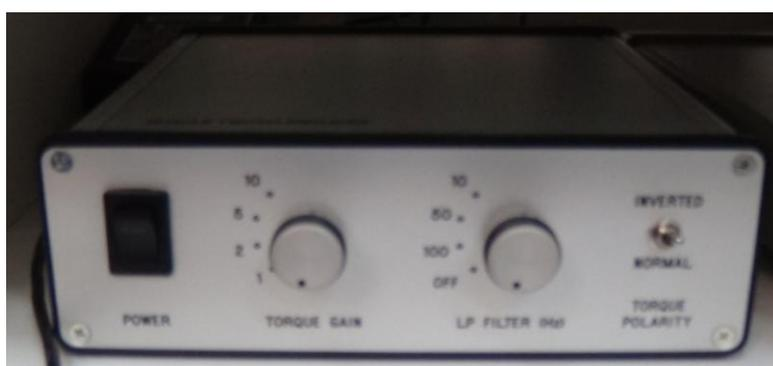
**FIGURA 6.** Equipamento de amplificação acoplado ao dinamômetro isocinético para avaliar a magnitude do torque com a estimulação elétrica com aumento de até 30 vezes.
