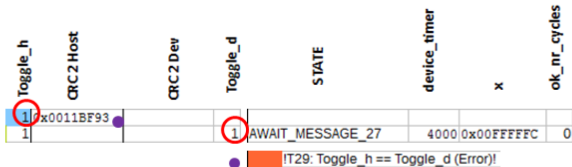
Figura 6.19 – F-Device não aceita mensagem do F-Host por falta de sincronia no Toggle_h
