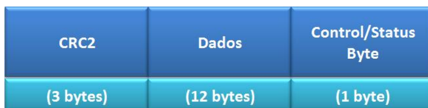
Figura 3.4 - Estrutura do Safety PDU com 12 bytes de dados
