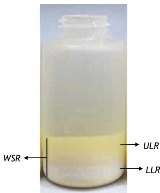
Figura 5.2: Fotografia do resíduo obtido na centrifugação, onde é possível observar a aparência do resíduo da camada superior (ULR) e do resíduo da camada inferior (LLR). O resíduo amiláceo integral (WSR) consiste na mistura destes dois produtos.
