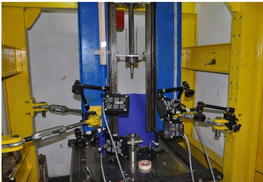
Figura 35 - Máquina de teste da Instron Dynatup 9250H (Laboratório de Mecânica dos Sólidos e Impacto em Estrutura/USP).
