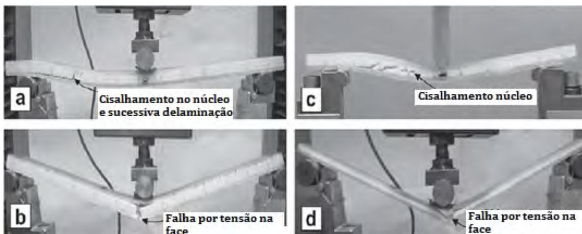
Figura 14- Fotos das amostras após a ruptura: Painel de estrutura sanduíche com núcleo de PVC com uma distância entre os apoios de 330 mm (a) e 380 mm (b) e estrutura sanduíche com núcleo de poliéster com uma distância entre os apoios de 166 mm (c) e 300 mm (d) (RUSSO, 2007).
