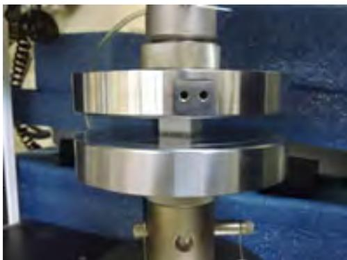
Figura 28 - Ensaio de compressão longitudinal da estrutura sanduíche.
