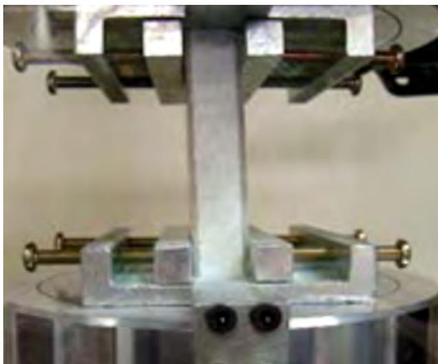
Figura 29 - Ensaio de compressão transversal para as estruturas sanduíche.
