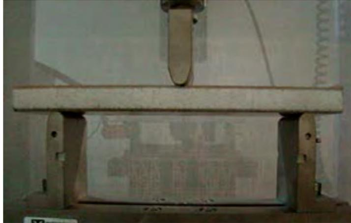
Figura 31 - Ensaio de flexão em 3 pontos da estrutura sanduíche.
