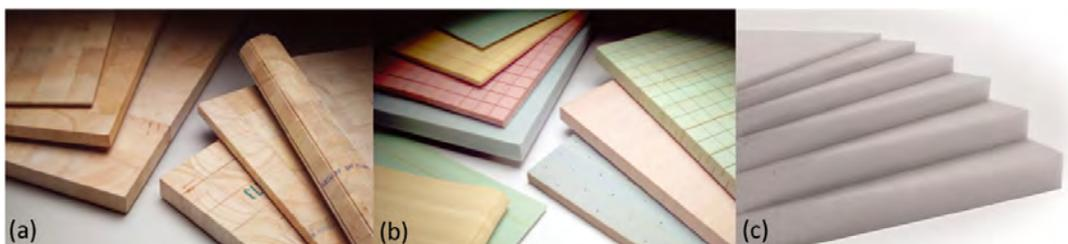
Figura 7 - Núcleo de madeira balsa (a), espuma de PVC (b) e espuma de PET (NASSEH, 2007).
