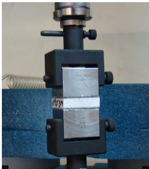
Figura 32 - Ensaio de resistência à tração das faces para as estruturas sanduíche.
