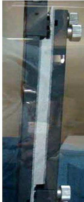
Figura 33 - Ensaio de cisalhamento da estrutura sanduíche.
