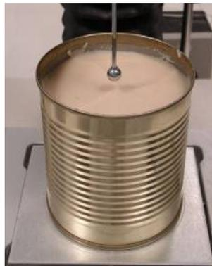
Figura 18: Sensor utilizado na determinação da força de ruptura e deformabilidade.
