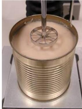
Figura 17: Sensor utilizado na determinação da dureza.
