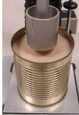
Figura 19: Sensor utilizado na determinação da força de penetração.
