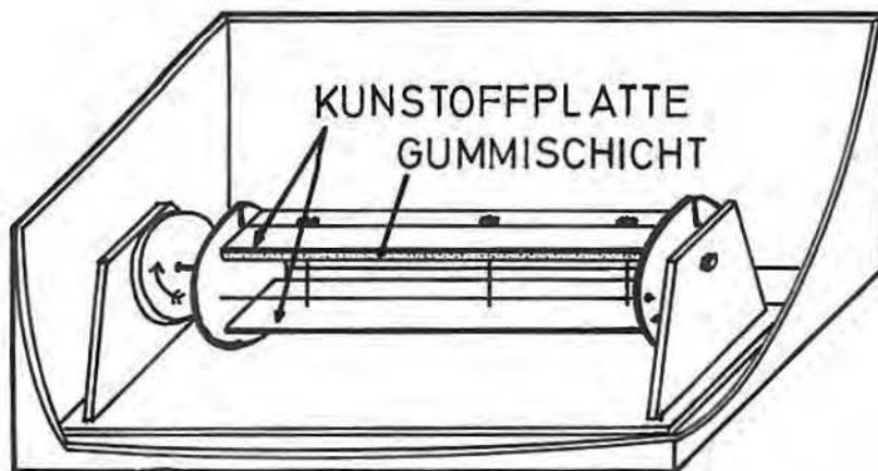
Abb. 1- Schematische Darstellung der Schüttelapparatur.
