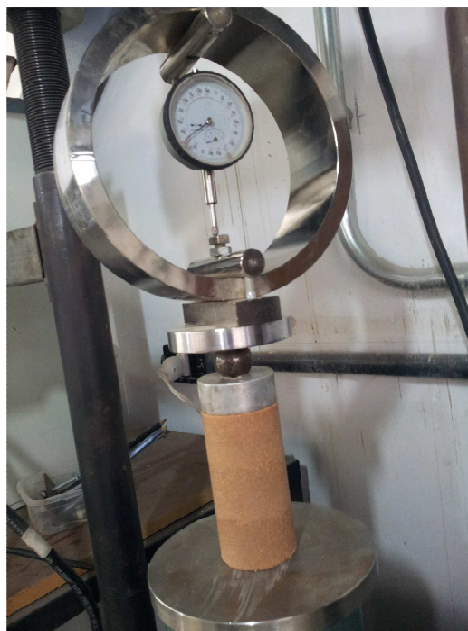
Figura 3-4: Ensaio de Resistencia à Compressão Simples.
