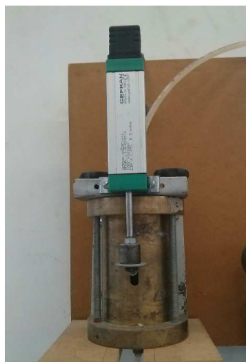
Figura 3-8: Medidor externo de variação volumétrica.
