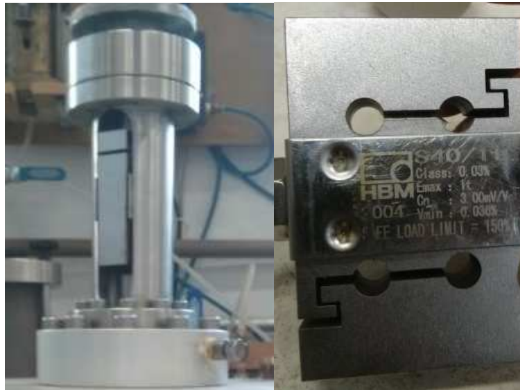
Figura 3-13: Célula de carga de medição externa.
