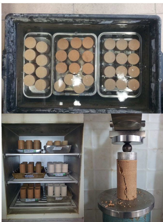
Figura 3-2: Ciclos de molhagem e secagem sem escovação e com ensaio de compressão simples.
