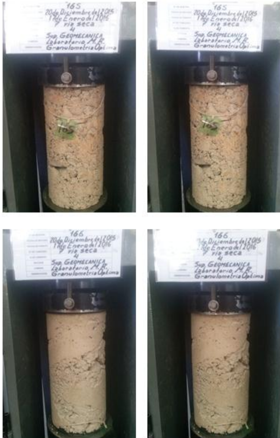
Figura 45 - Corpos de prova 165 e 166 antes e depois da execução do ensaio de compressão uniaxial
