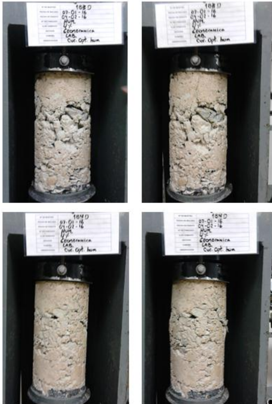
Figura 54 - Corpos de prova 183 e 184 antes e depois da execução do ensaio de compressão uniaxial
