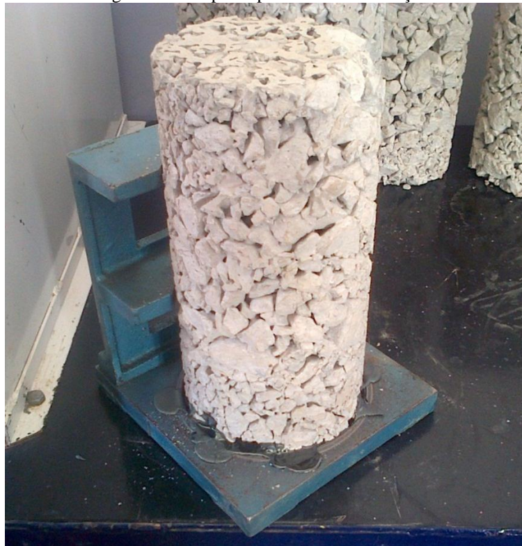
Figura 21 - Corpo de prova sendo encabeçada
