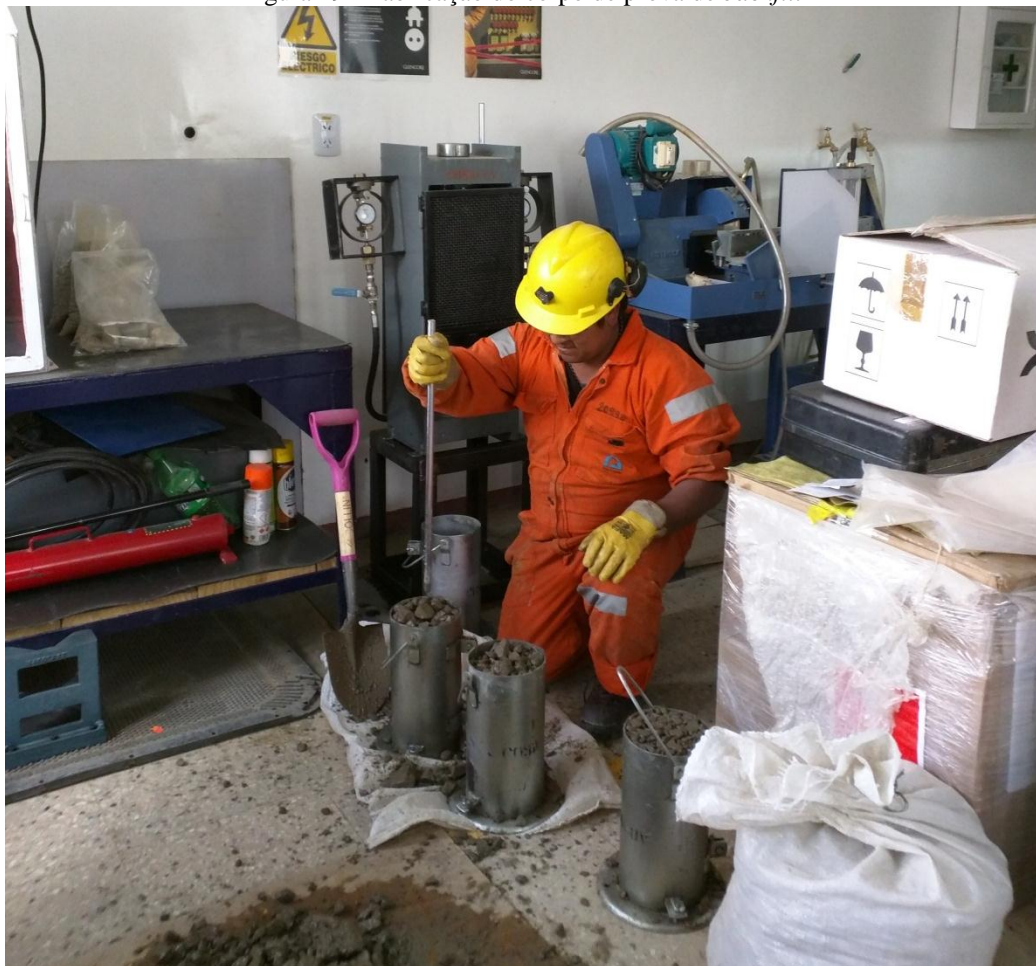
Figura 19 - Fabricação do corpo de prova de backfill
