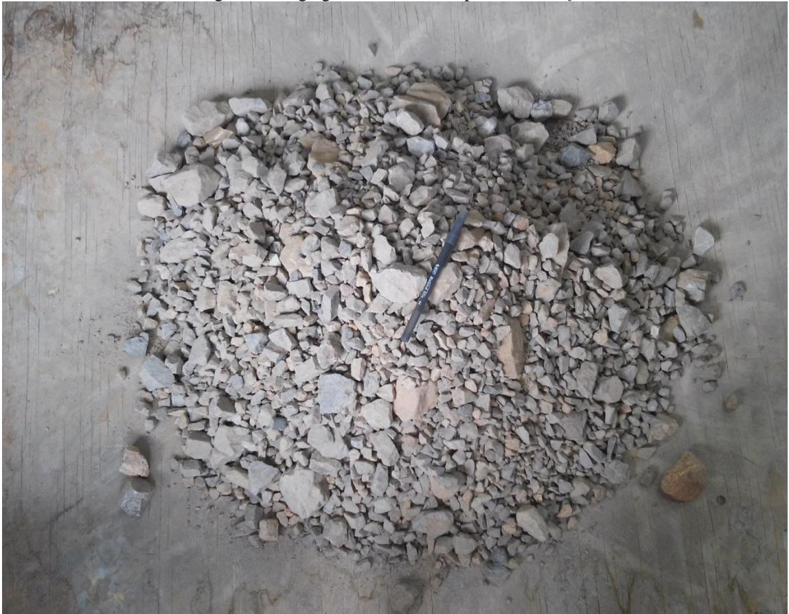
Figura 13 - Agregado amostrado na planta de backfill
