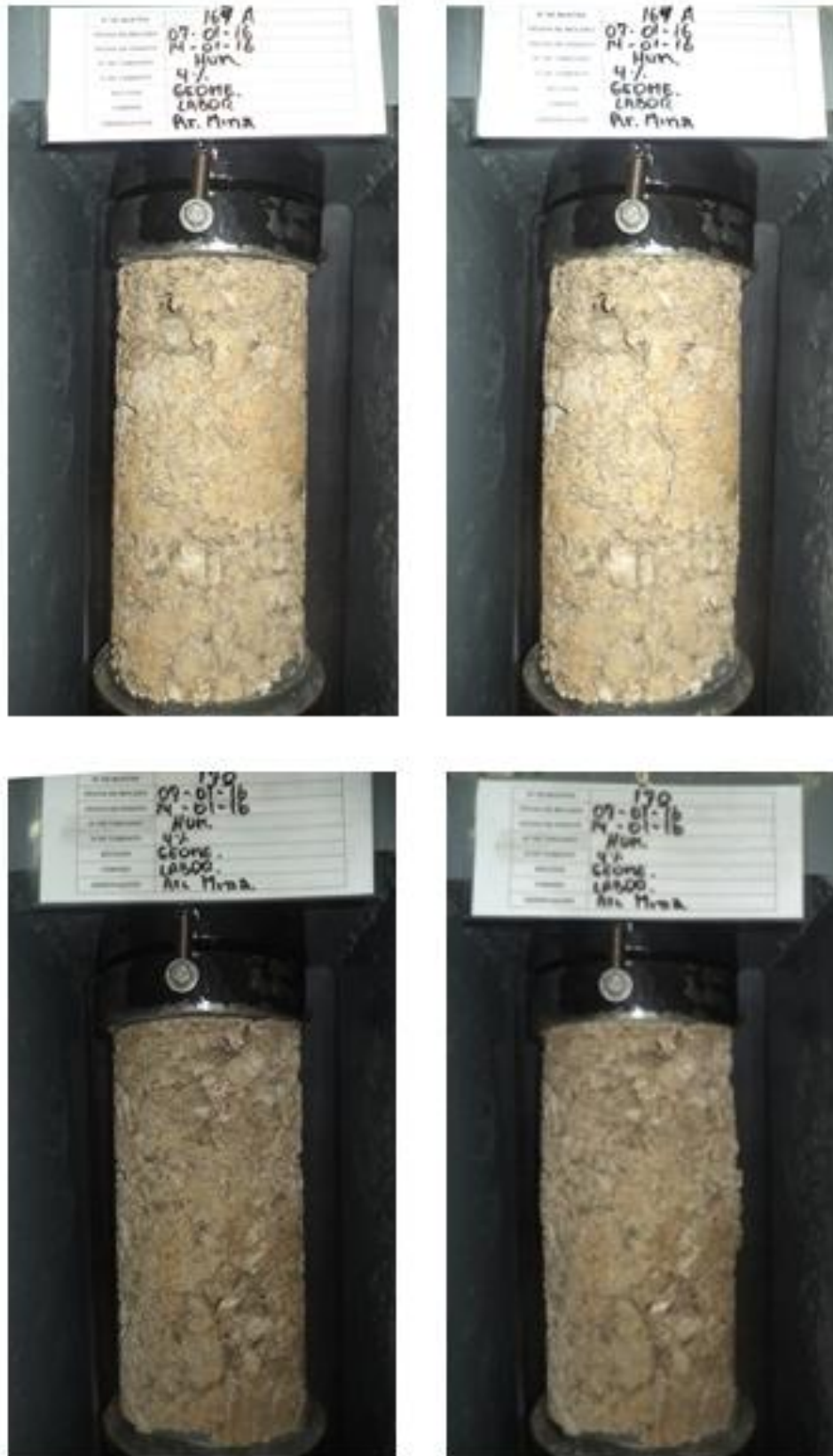
Figura 47 - Corpos de prova 169 e 170 antes e depois da execução do ensaio de compressão uniaxial
