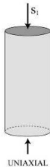
Figura 8 - Corpo de prova cilíndrico e direção da tensão uniaxial
