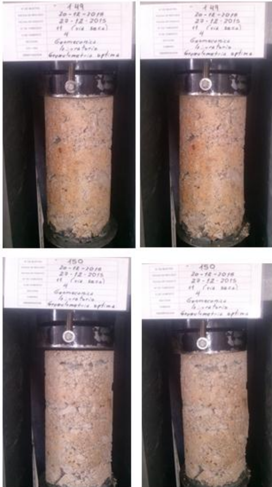
Figura 37 - Corpos de prova 149 e 150 antes e depois da execução do ensaio de compressão uniaxial
