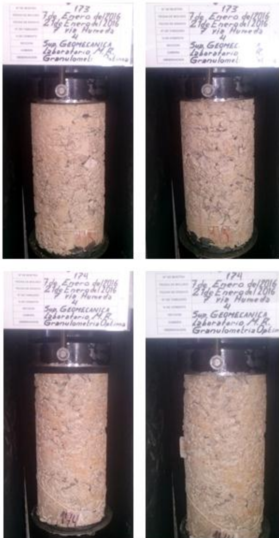
Figura 49 - Corpos de prova 173 e 174 antes e depois da execução do ensaio de compressão uniaxial
