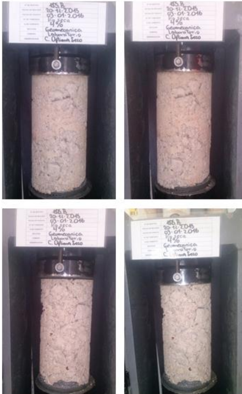
Figura 40 - Corpos de prova 155 e 156 antes e depois da execução do ensaio de compressão uniaxial
