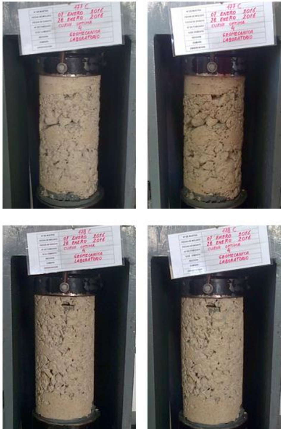
Figura 51 - Corpos de prova 177 e 178 antes e depois da execução do ensaio de compressão uniaxial
