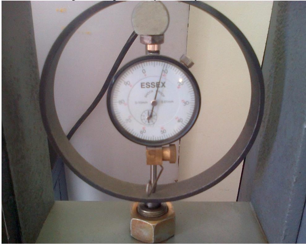
Figura 23 - Registro de força máxima aplicada em kN
