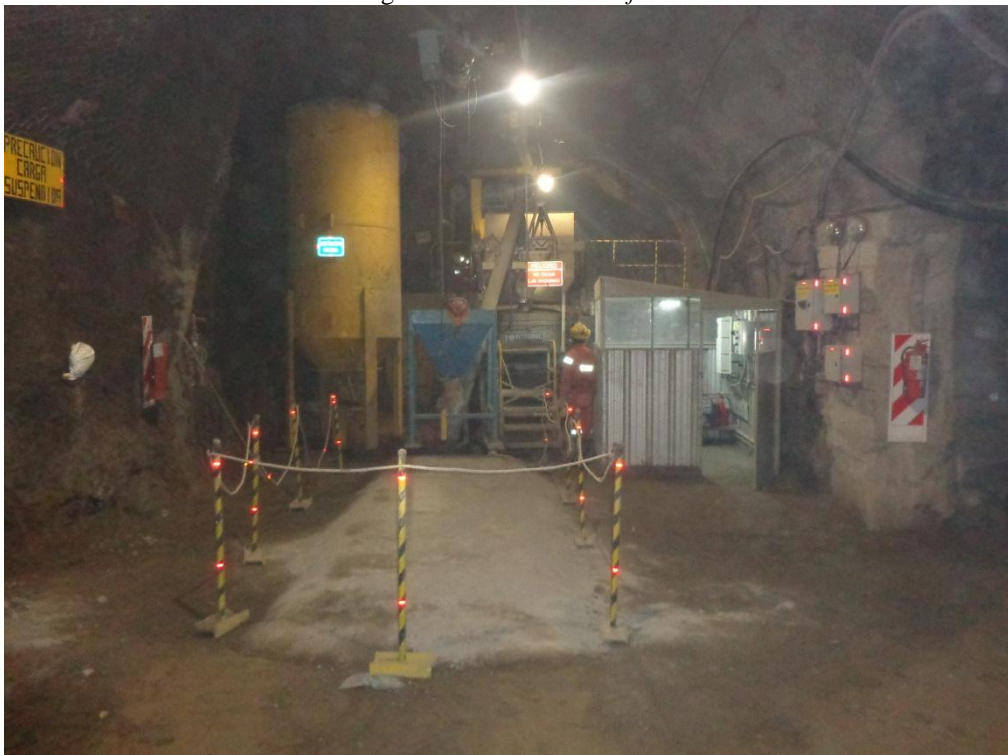
Figura 6 - Planta de Backfill
