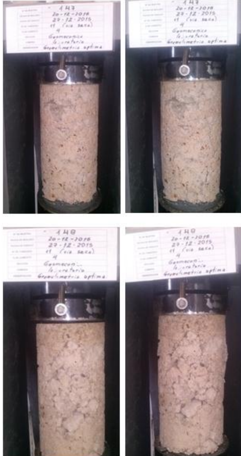
Figura 36 - Corpos de prova 147 e 148 antes e depois da execução do ensaio de compressão uniaxial
