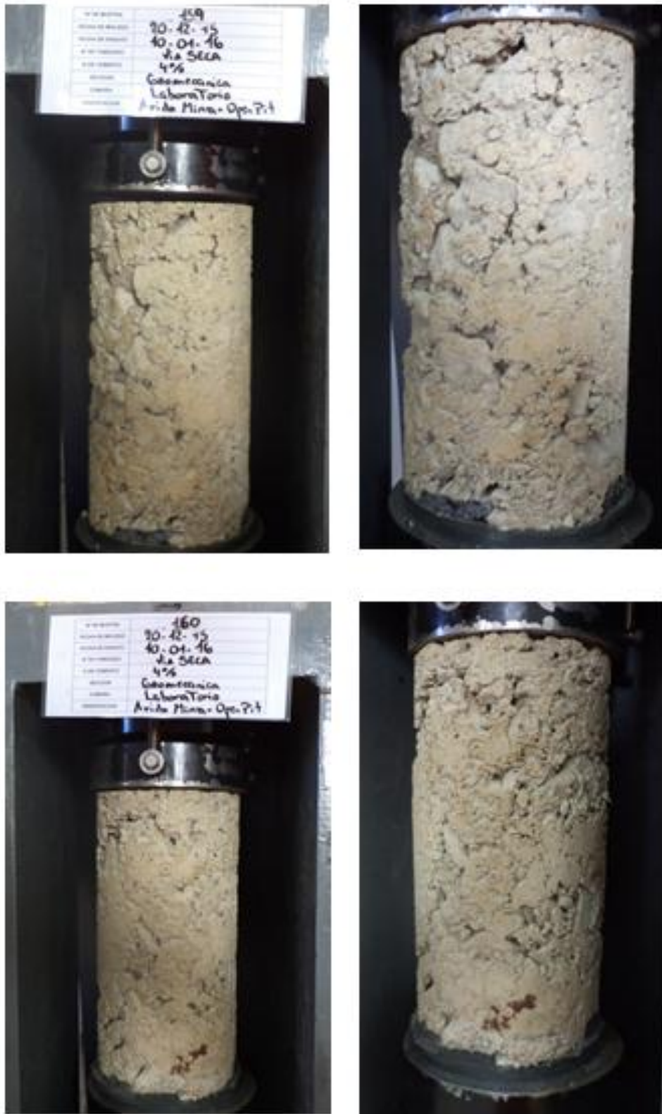
Figura 42 - Corpos de prova 159 e 160 antes e depois da execução do ensaio de compressão uniaxial
