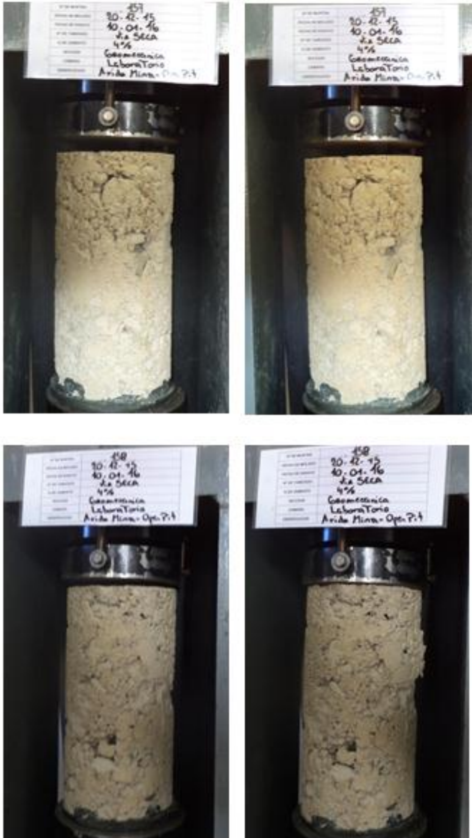
Figura 41 - Corpos de prova 157 e 158 antes e depois da execução do ensaio de compressão uniaxial
