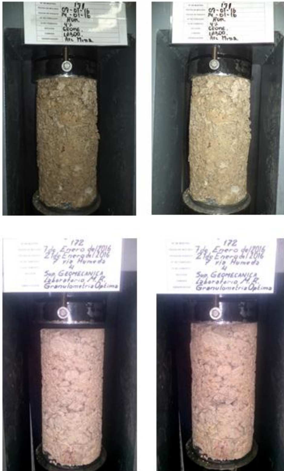
Figura 48 - Corpos de prova 171 e 172 antes e depois da execução do ensaio de compressão uniaxial
