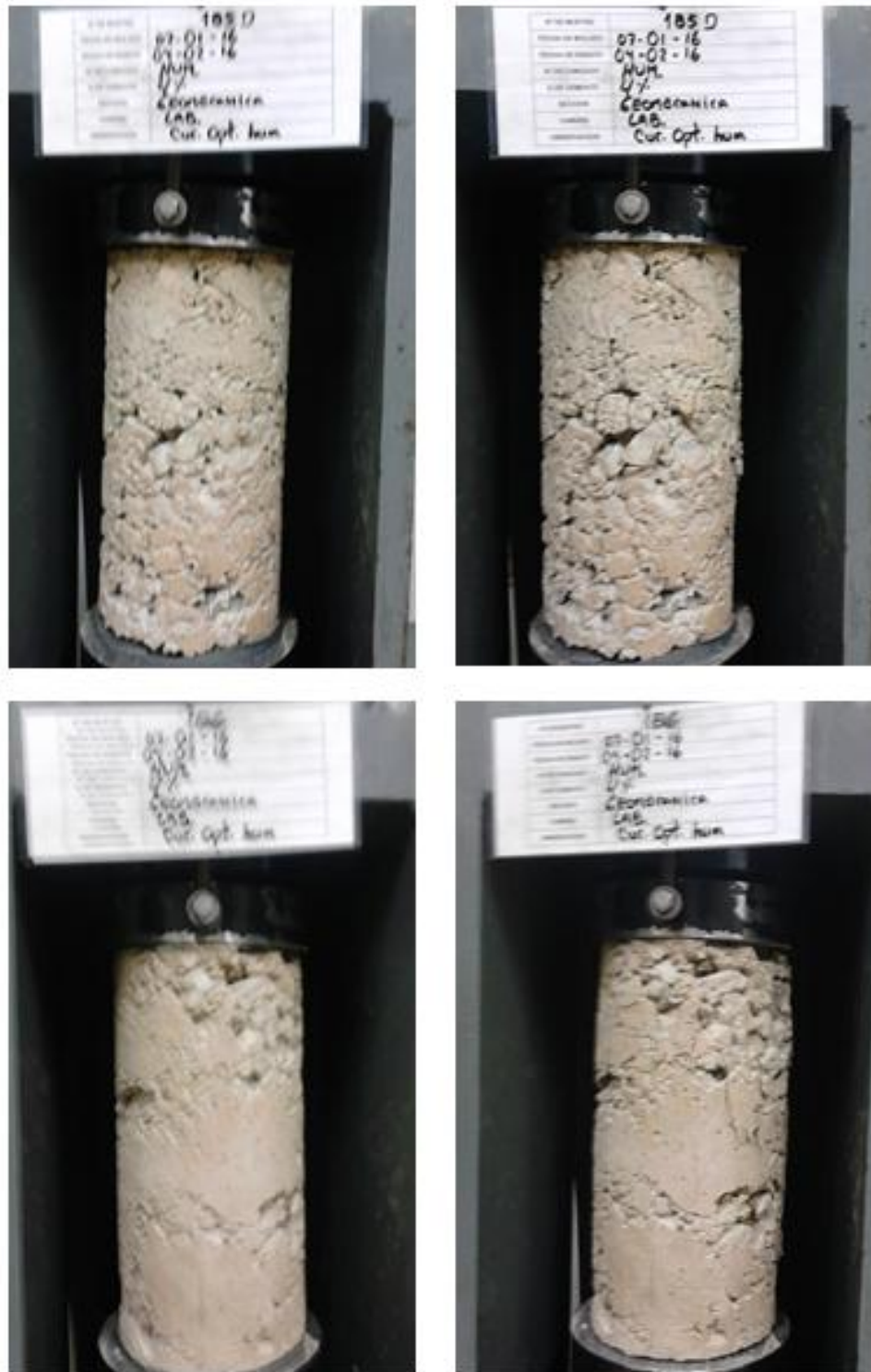
Figura 55 - Corpos de prova 185 e 186 antes e depois da execução do ensaio de compressão uniaxial
