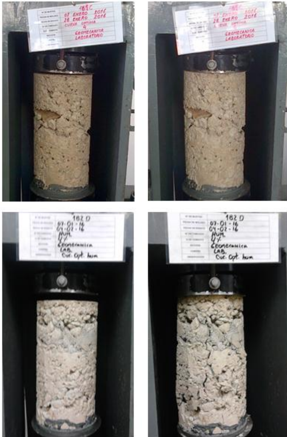
Figura 53 - Corpos de prova 181 e 182 antes e depois da execução do ensaio de compressão uniaxial
