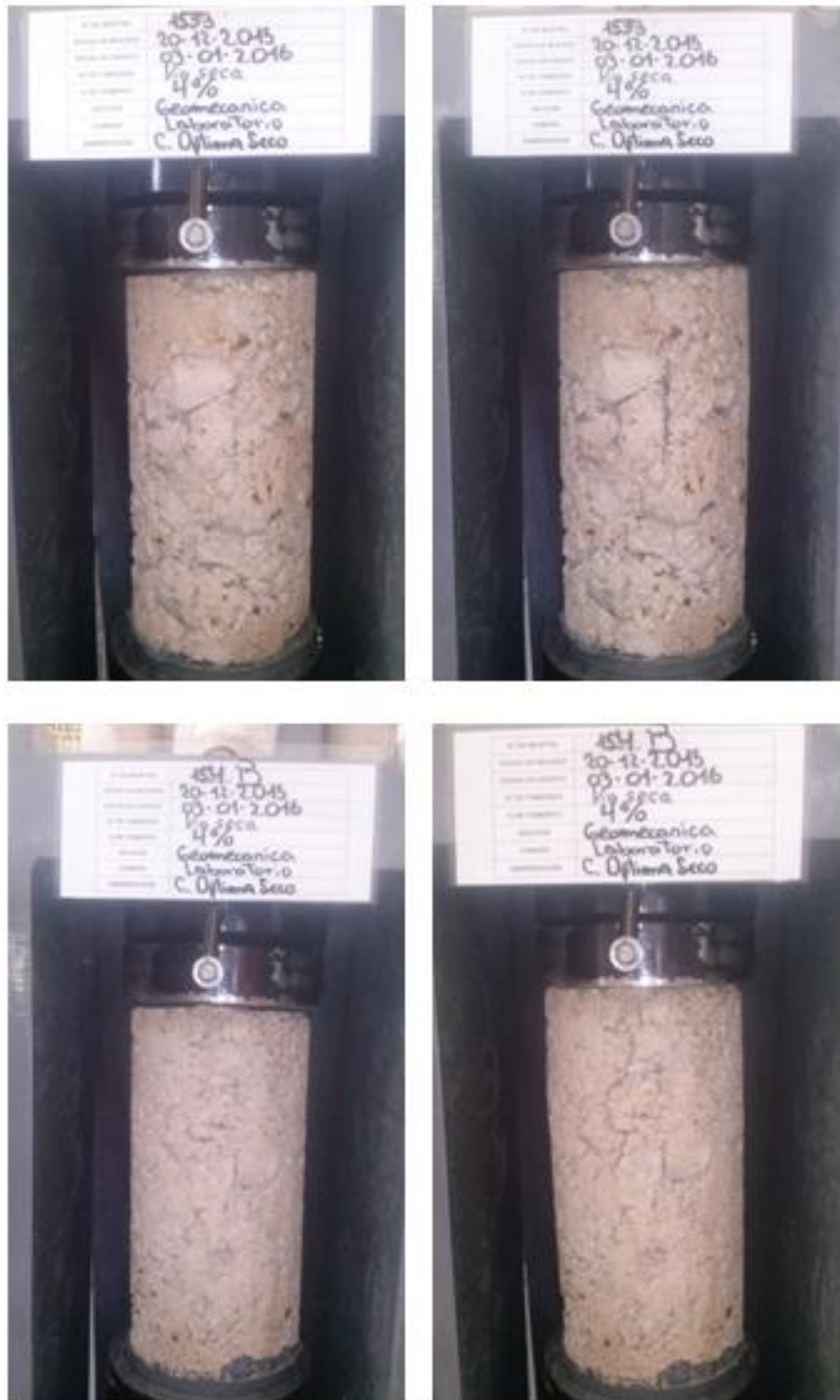
Figura 39 - Corpos de prova 153 e 154 antes e depois da execução do ensaio de compressão uniaxial
