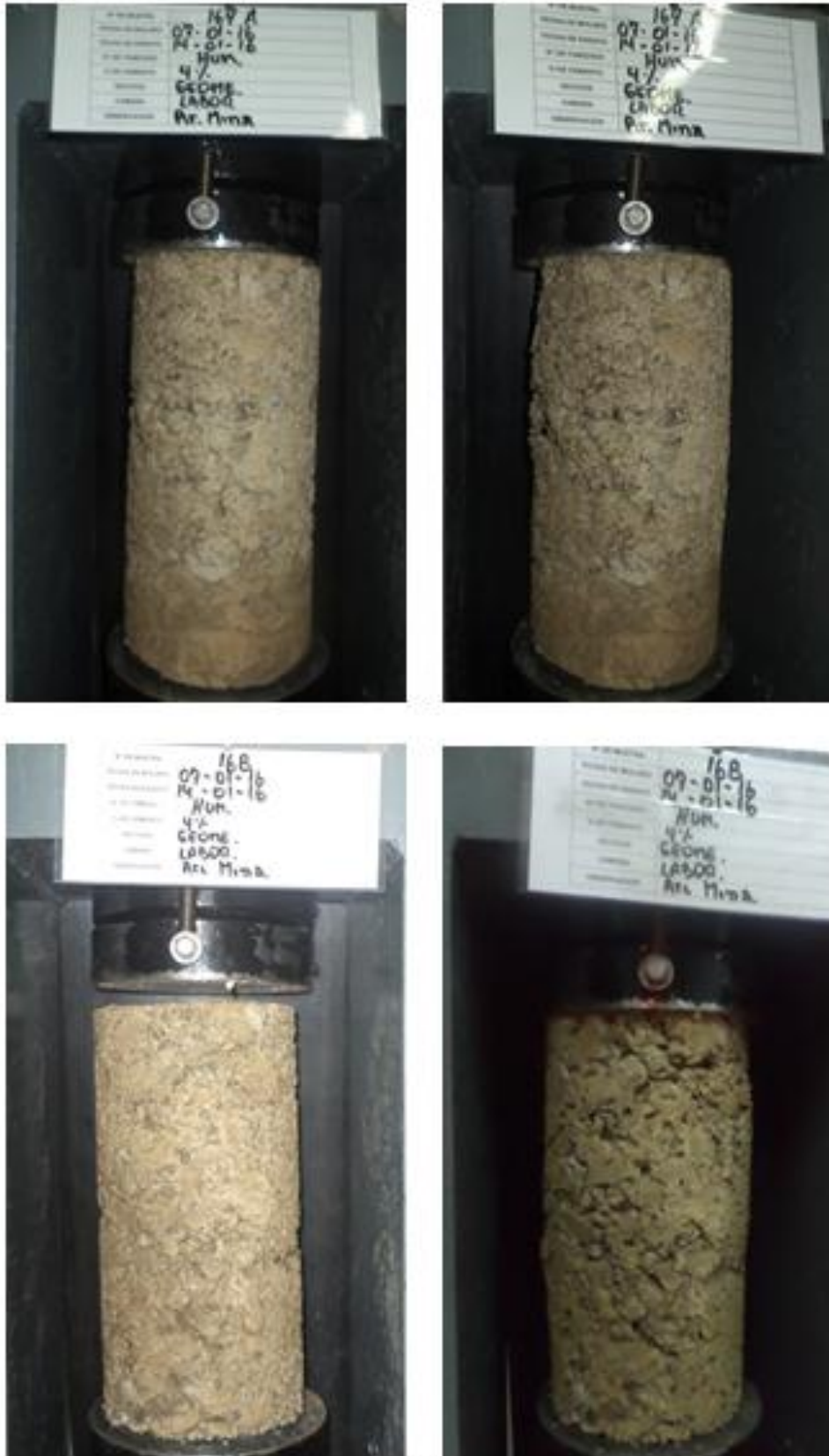
Figura 46 - Corpos de prova 167 e 168 antes e depois da execução do ensaio de compressão uniaxial
