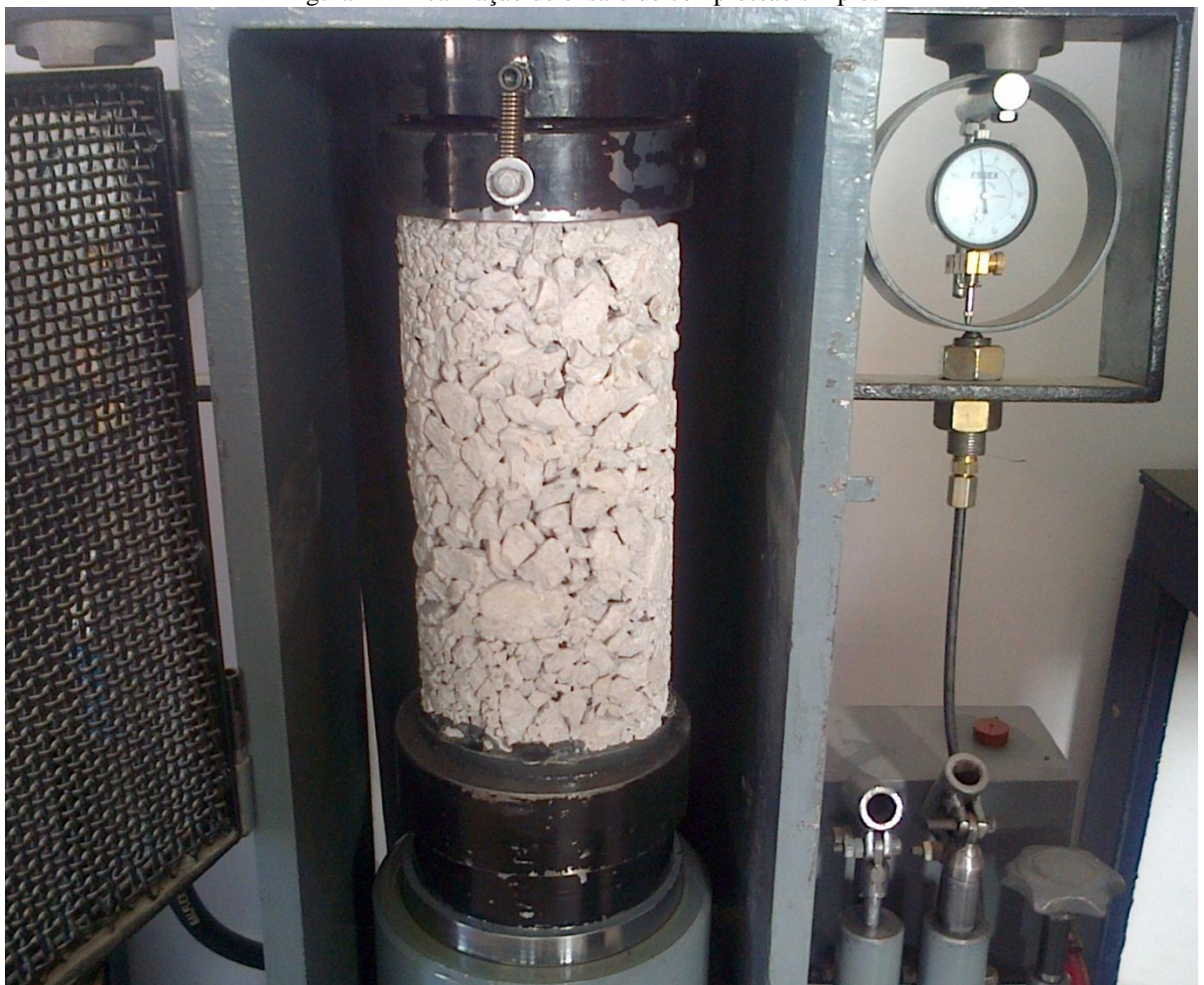
Figura 22 - Realização de ensaio de compressão simples
