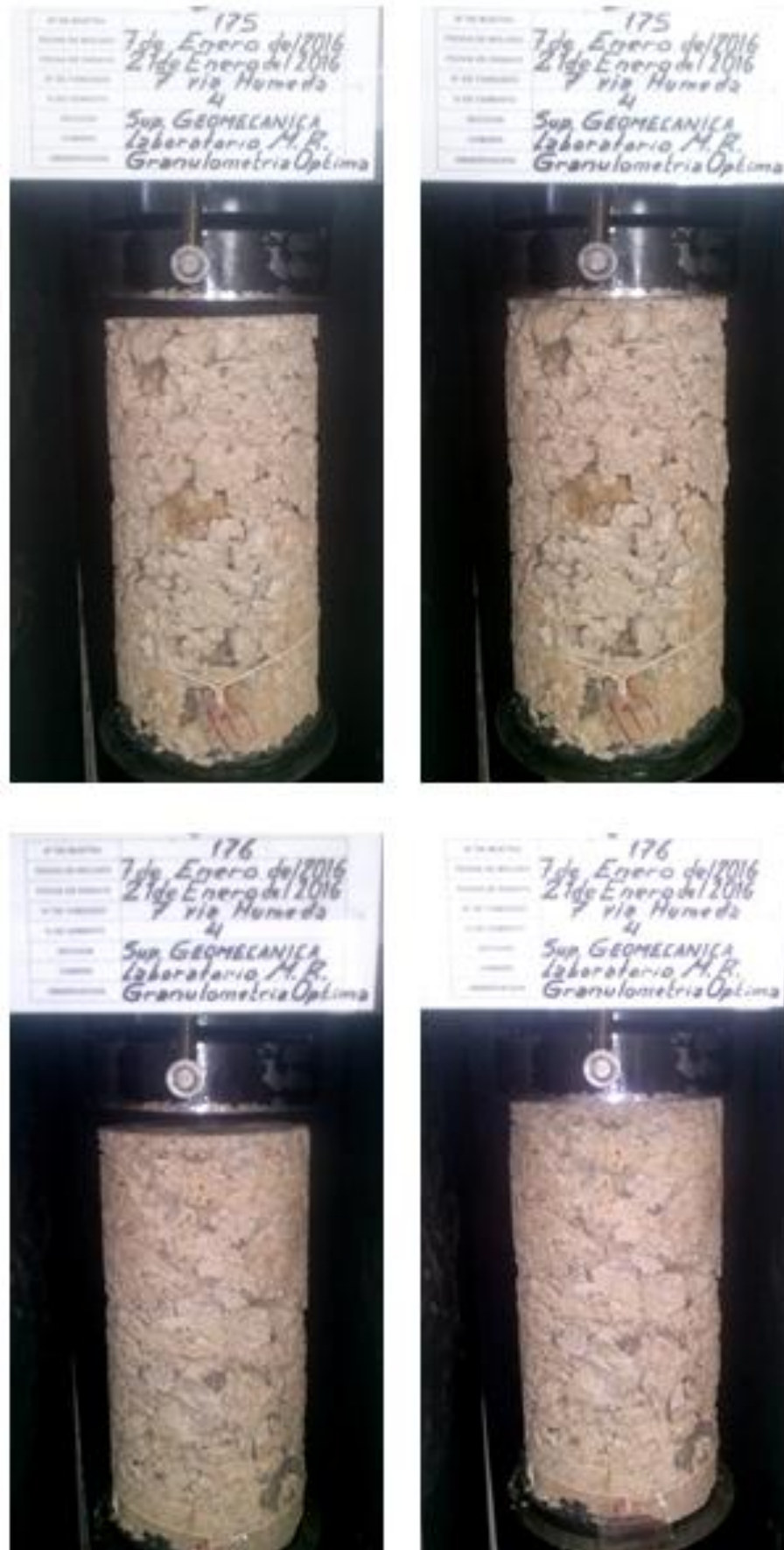
Figura 50 - Corpos de prova 175 e 176 antes e depois da execução do ensaio de compressão uniaxial
