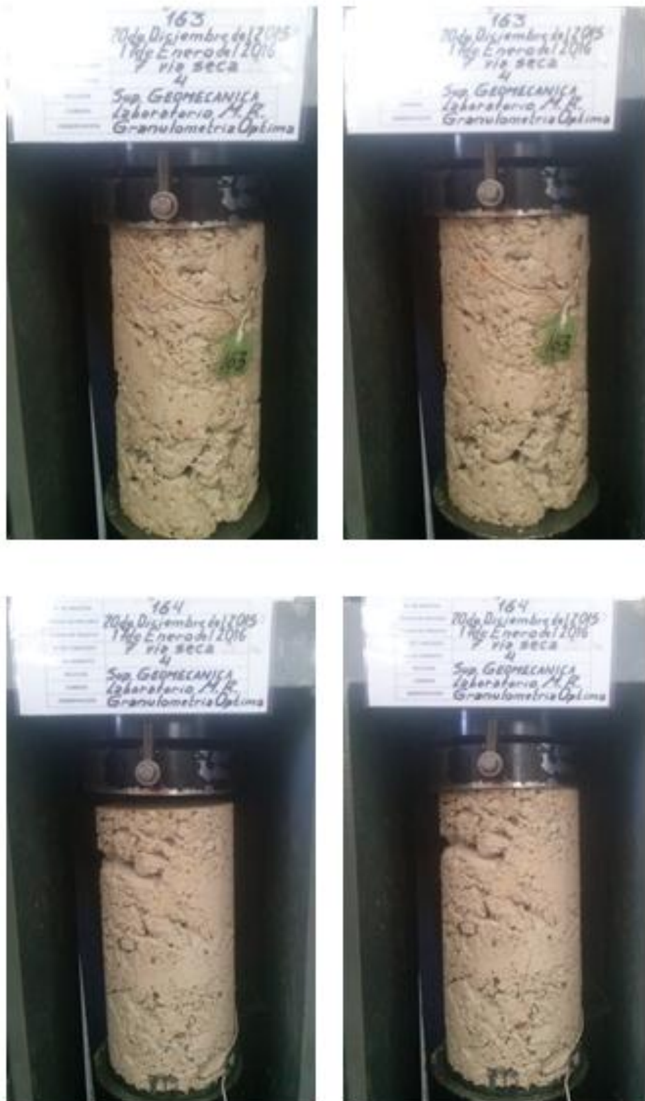
Figura 44 - Corpos de prova 163 e 164 antes e depois da execução do ensaio de compressão uniaxial
