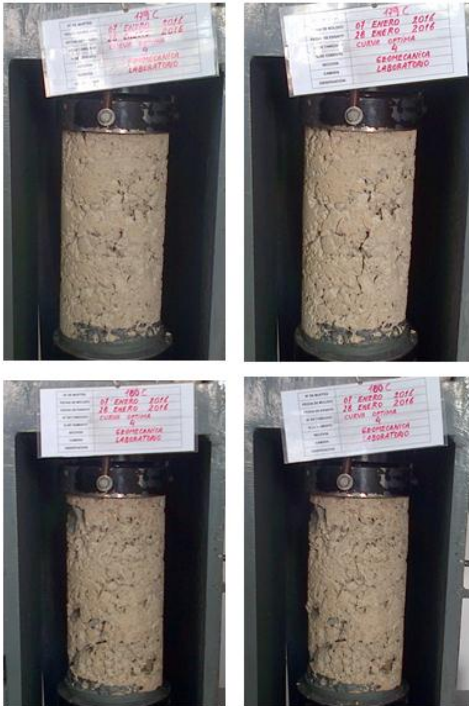
Figura 52 - Corpos de prova 179 e 180 antes e depois da execução do ensaio de compressão uniaxial
