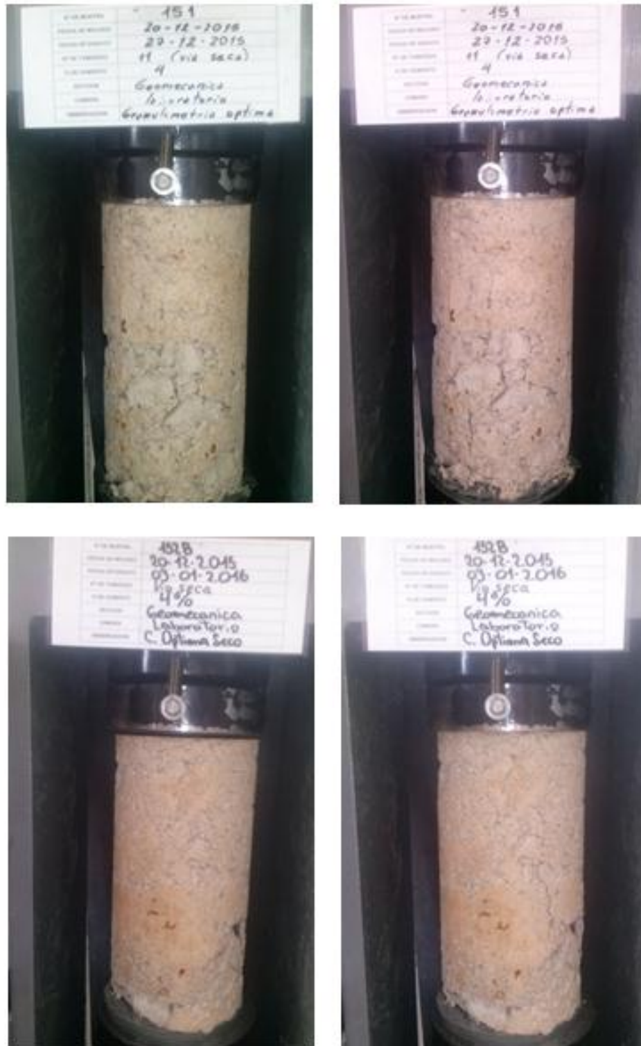
Figura 38 - Corpos de prova 151 e 152 antes e depois da execução do ensaio de compressão uniaxial
