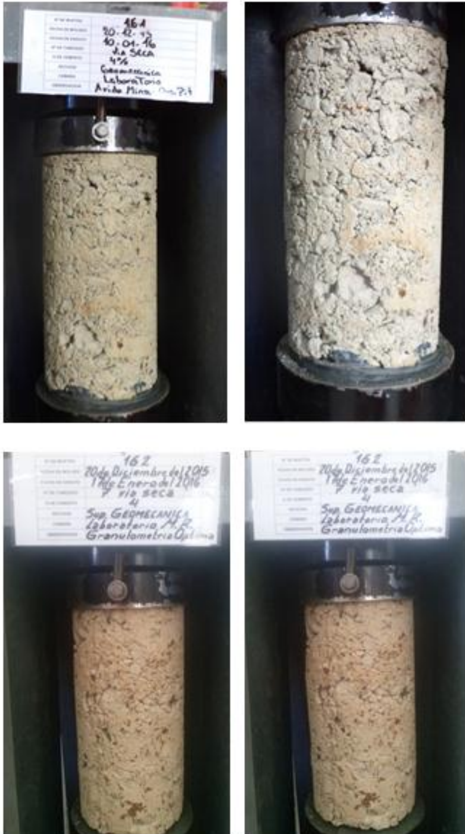
Figura 43 - Corpos de prova 161 e 162 antes e depois da execução do ensaio de compressão uniaxial
