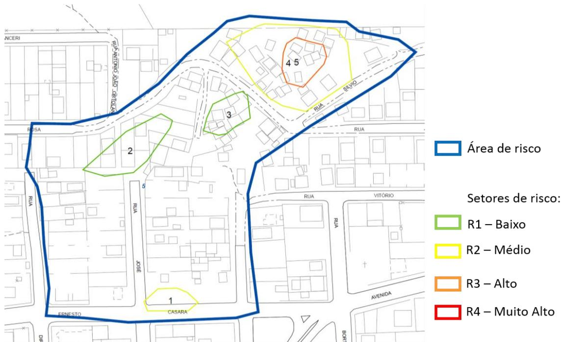
Figura 6: Áreas e Setores de Risco de assentamento precário em Caxias do Sul/RS (adaptado de PROFILL ENGENHARIA E AMBIENTE, 2006).
