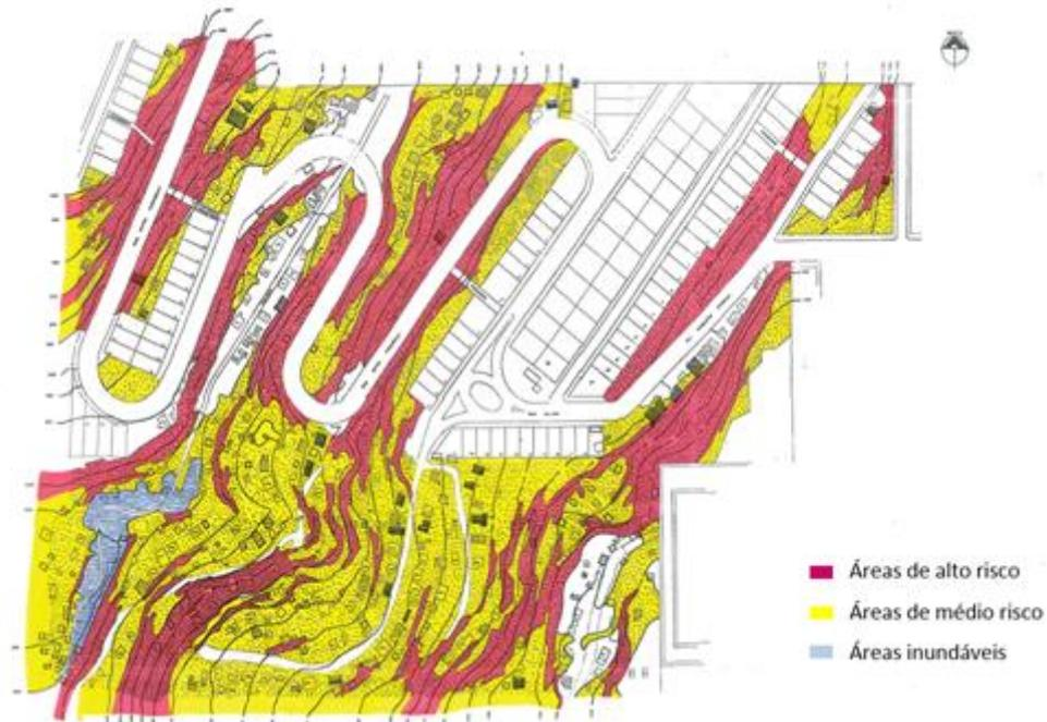
Figura 36: COOESP - Mapeamento de áreas de risco (BRESSANI et al., 1998).
