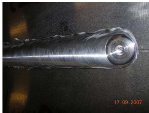
Figura 4.10. Soldagem utilizando a ferramenta da Figura 4.9 em chapa Alclad AA2024-T3.
