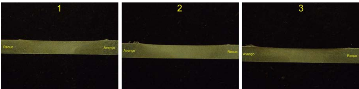
Figura 5.2. Seção transversal da solda utilizando a liga AA2024-T3.
