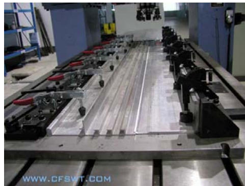
Figura 3.22. Equipamento de soldagem FSW desenvolvida pela Beijing FSW Technology [CFSWC, 2007].
