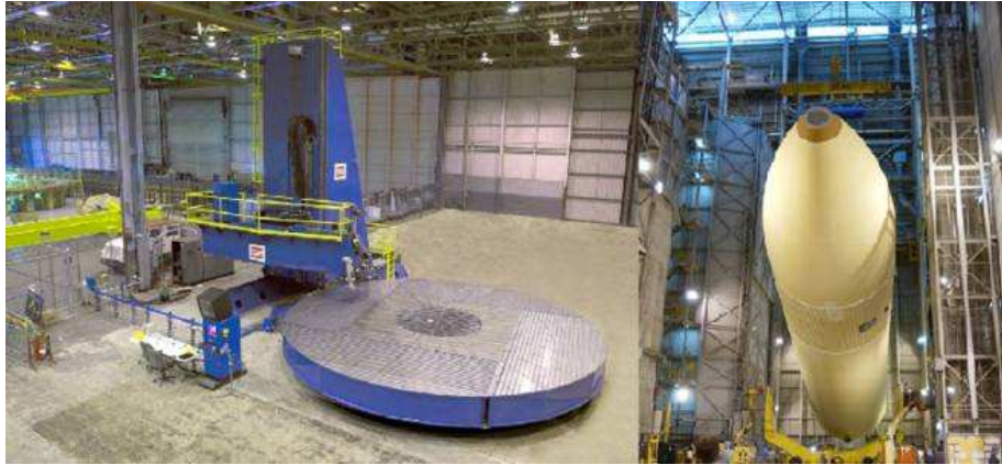
Figura 3.5. Equipamento de FSW dos tanques de combustíveis do ônibus espacial [Júnior, 2003].
