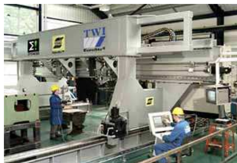
Figura 3.21. ESAB SuperStir TM instalada pela TWI no laboratório de FSW em Abington, Inglaterra. Permite a soldagem de alumínio entre 1mm e 25mm de espessura, com uma força axial de até 60kN (6 ton) e velocidade máxima de 5000 RPM [Kim et al., 2006].
