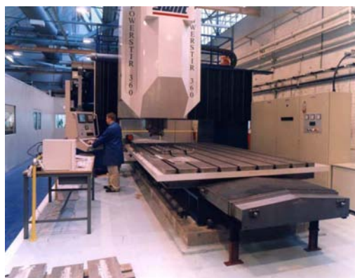
Figura 3.24. Powerstir 360 fabricado pela Crawford Swift. Controle numérico computadorizado de três eixos com 5 graus de liberdade produzida para suportar até 10 toneladas com a mínima distorção [Wyatt, 2007].
