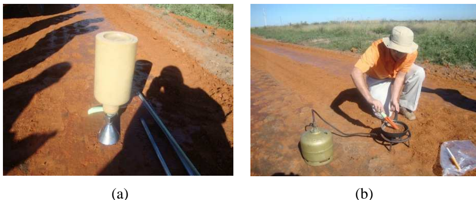
Figura 34: ensaios realizados a campo. (a) ensaio de frasco de areia; (b) determinação da umidade do solo através do Método da frigideira.
