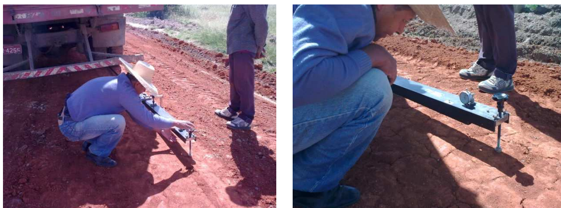
Figura 36: levantamento de deflexões sobre a camada inferior de revestimento primário.
