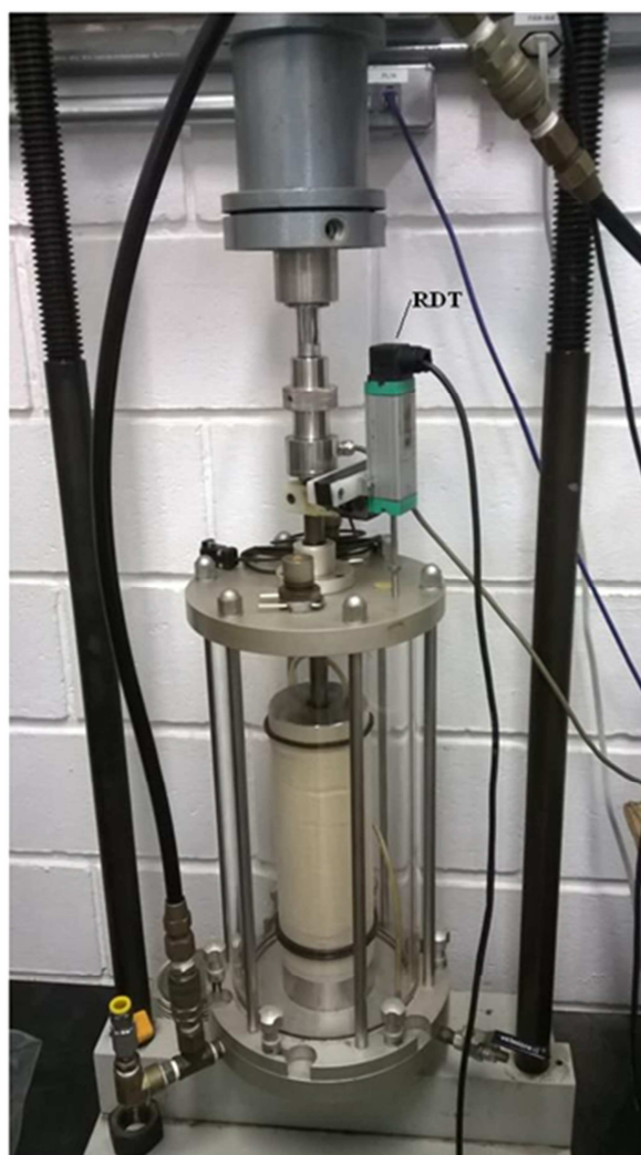
Figura 42: câmara utilizada nos ensaios triaxiais de carga repetida. Ensaio para a determinação de deformações permanentes em curso, com o emprego de um RDT ( Rectilinear Displacement Transducer )
