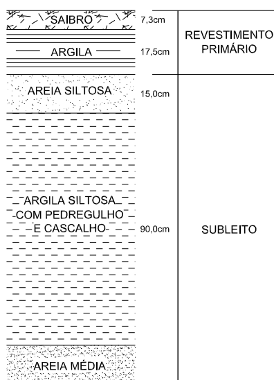
Figura 70: seção típica da estrutura do pavimento analisado.
