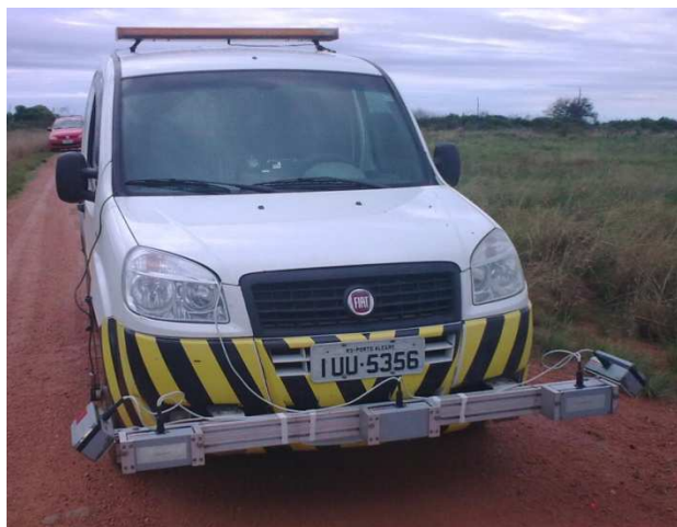
Figura 37: equipamento utilizado nos levantamentos de Irregularidades Longitudinais.
