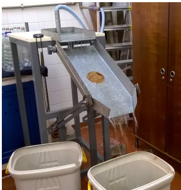
Figura 38: ensaio de Inderbitzen.
