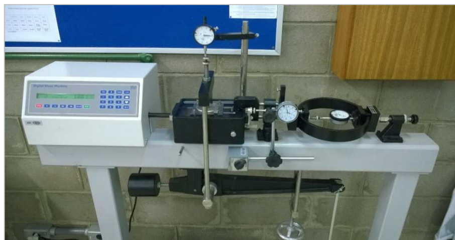
Figura 41: equipamento utilizado nos ensaios de cisalhamento direto.
