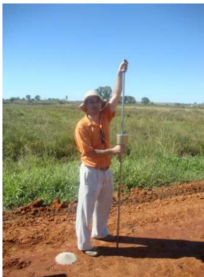
Figura 35: realização do ensaio DCP.
