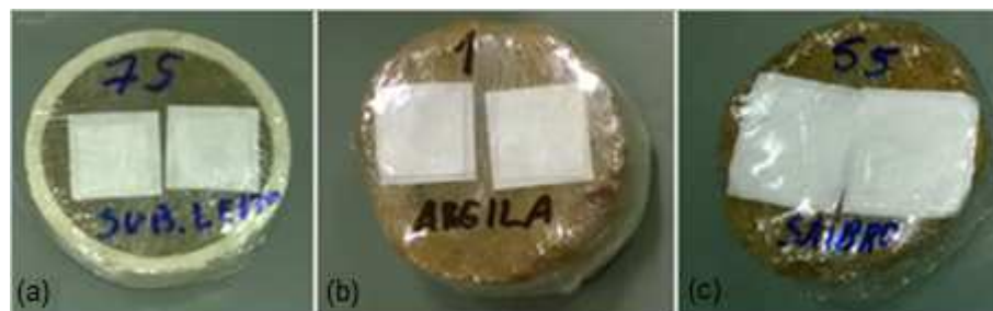
Figura 40: conjuntos utilizados para a obtenção das curvas de retenção. (a) solo do subleito; (b) argila e (c) saibro.
