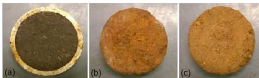
Figura 39: corpos de prova preparados para realização dos ensaios de obtenção das curvas de retenção. (a) solo do subleito; (b) argila e (c) saibro.
