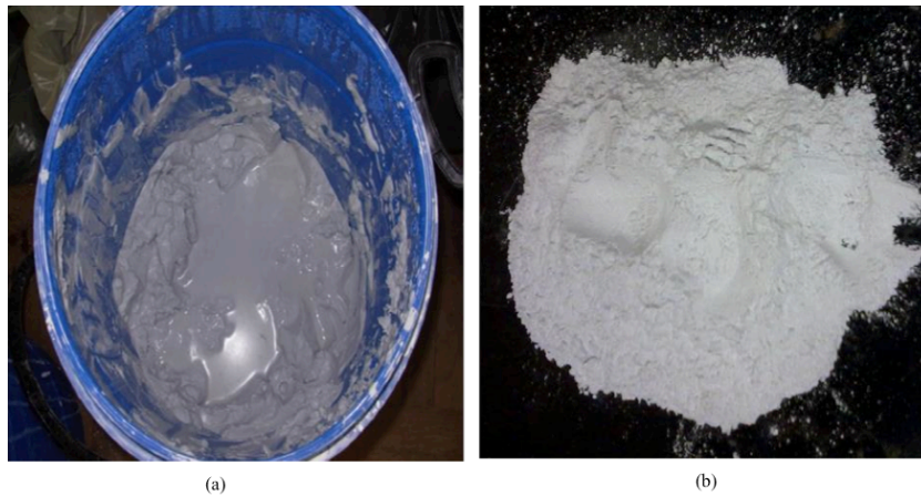
Figura 28 – Cal de carbureto da White Martins Gases Industriais S.A. (a) armazenada (b) após secagem
