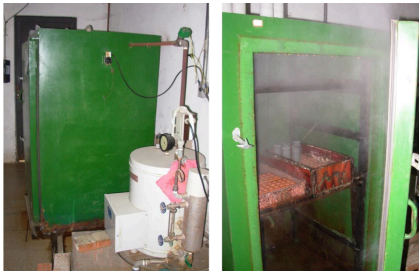
Figura 36 – Câmara a vapor utilizada para cura a vapor nas temperaturas de 40°C e 60°C
