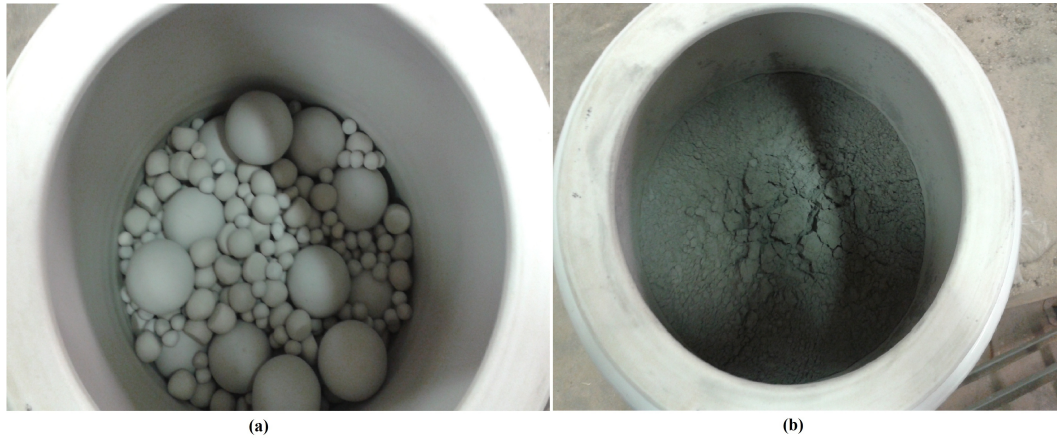
Figura 30 – Processo de moagem (a) acondicionamento das esferas no jarro (b) adição da cinza volante
