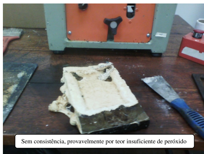
Figura 58: Problemas de qualidade na prensagem térmica das placas [autor].
