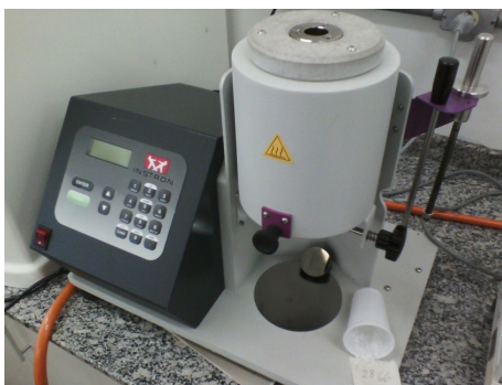
Figura 24: Plastômero para ensaio de índice de fluides [autor].
