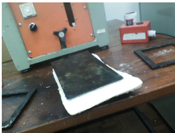
Figura 19: Imagem de placa expandida obtida por compressão térmica [autor].
