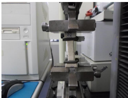
Figura 23: Equipamento para ensaio de tração [autor].
