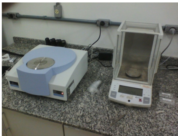
Figura 25: Equipamento para ensaio TGA [autor].
