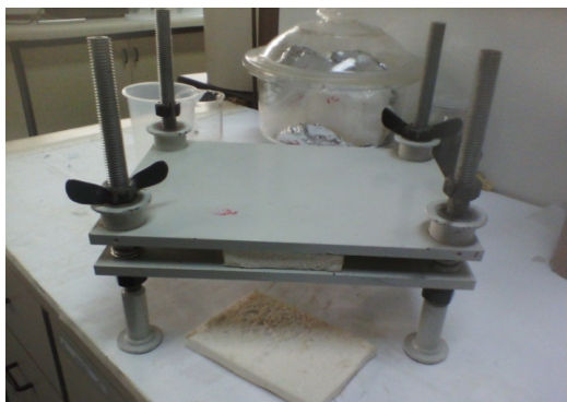
Figura 21: Equipamento utilizado no ensaio de DPC [autor].
