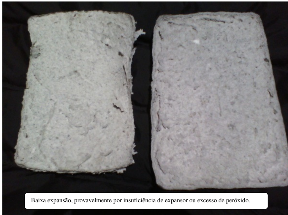
Figura 60: Problemas de qualidade na prensagem térmica das placas [autor].
