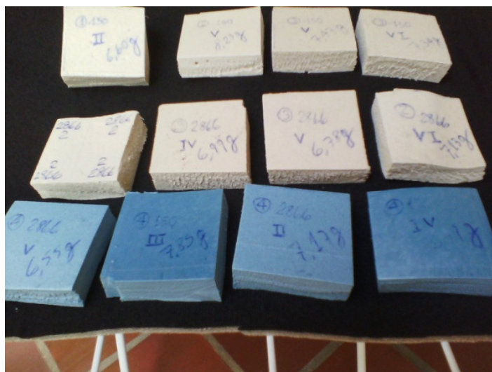
Figura 17: Corpos de prova para ensaios de densidade, compressão e compression set , onde superior: EVARI-0 aglutinado, médio: EVARI-10 aglutinado, inferior:EVARI-10 micronizado [autor].
