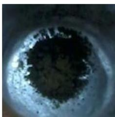
**Figura 14.** Resíduo obtido após aquecimento da amostra de coque a 500 °C em forno mufla.
