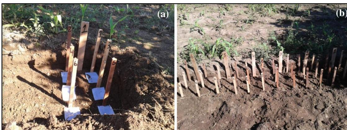
**Figura 19.** Fotografia ilustrando o ensaio de biodegradação no solo: a) Preparo do canteiro e (b) Disposição final das amostras no canteiro preparado para 6 meses de ensaio de biodegradação.
