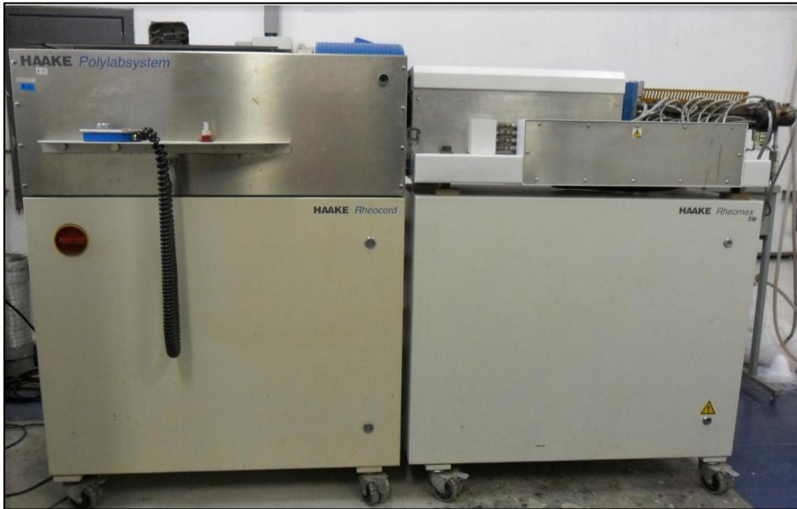
**Figura 16.** Extrusora utilizada para a preparação das amostras de PBAT/nisina.
