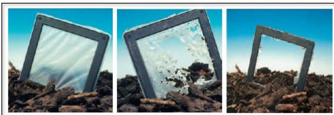
**Figura 5.** Biodegradação de um filme de Ecoflex<sup>®</sup> (PBAT) após 4 semanas no solo a 55°C<sup>4</sup>.
