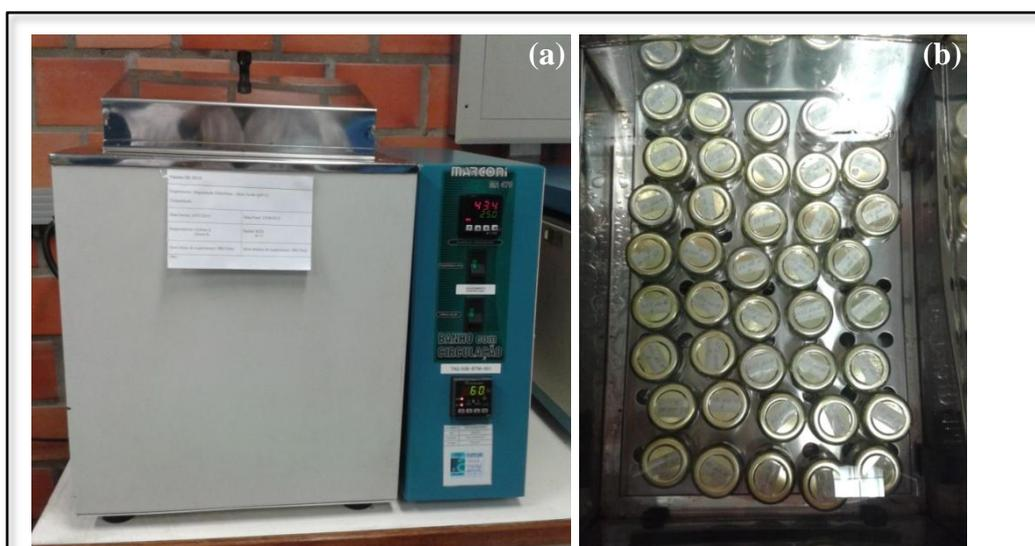
**Figura 22.** Degradação hidrolítica: a) Banho com recirculação utilizado para realização do experimento e b) disposição dos frascos dentro do banho durante o período do ensaio.
