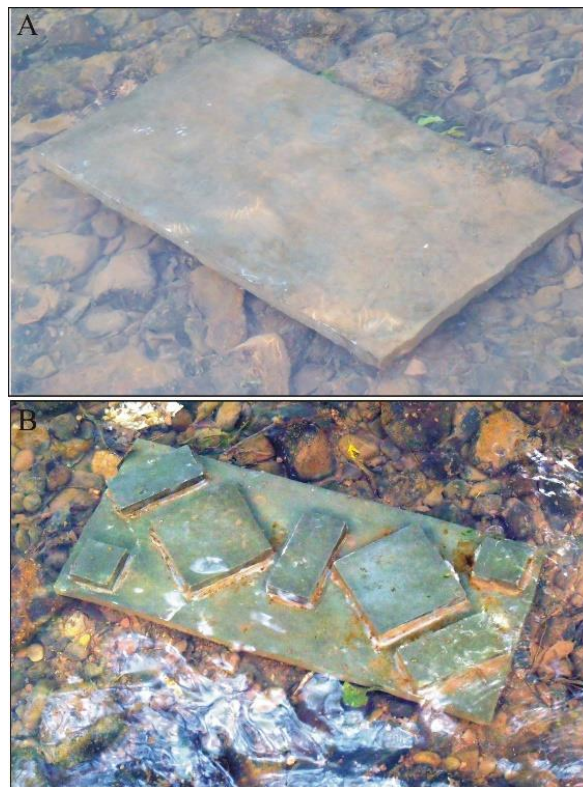
Figura 1. Amostradores artificiais utilizados no experimento. (A) Substrato homogêneo com superfície lisa. (B) Substrato heterogêneo com pedaços colados para aumentar a heterogeneidade.
