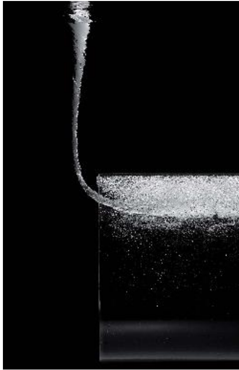
Figura 15 -Vórtice desenvolvido desde a superfície, com entrada de ar, em uma tubulação transparente (fonte: Möller 2013)
