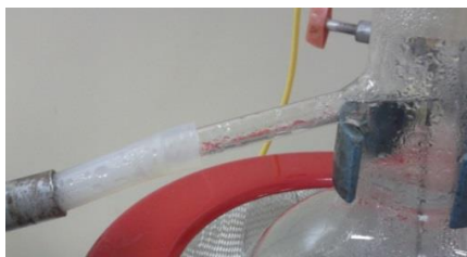
Figura 8.8: Imagem da formação de gotas no percurso da condensação.
