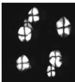
Figura 2.4: Grânulos de amido nativos exibindo a cruz de malta (birrefringência) sob a luz polarizada. FONTE: Blaszczak et al. (2005) apud Beninca (2008).
