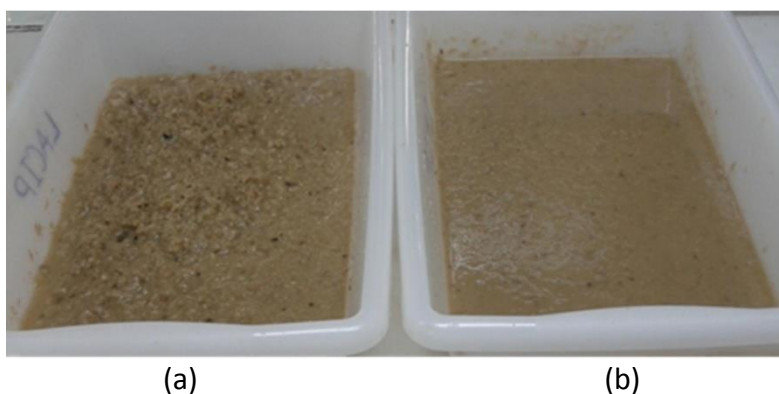
Figura 9.1: Imagem comparativa de fermentação, sem processo de enzimático de redução de viscosidade e sólidos (a) e com (b).
