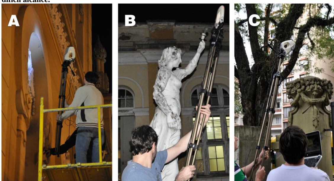
Figura 34: Uso do extensor acoplado ao Artec Eva para a digitalização tridimensional de locais de difícil alcance.
