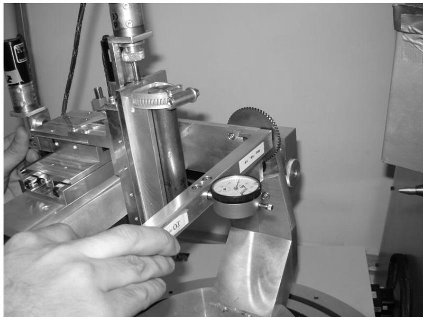
**Figura 4-6 - Ajuste da amostra na altura "zero", utilizando o ajuste "Z" do equipamento.**
