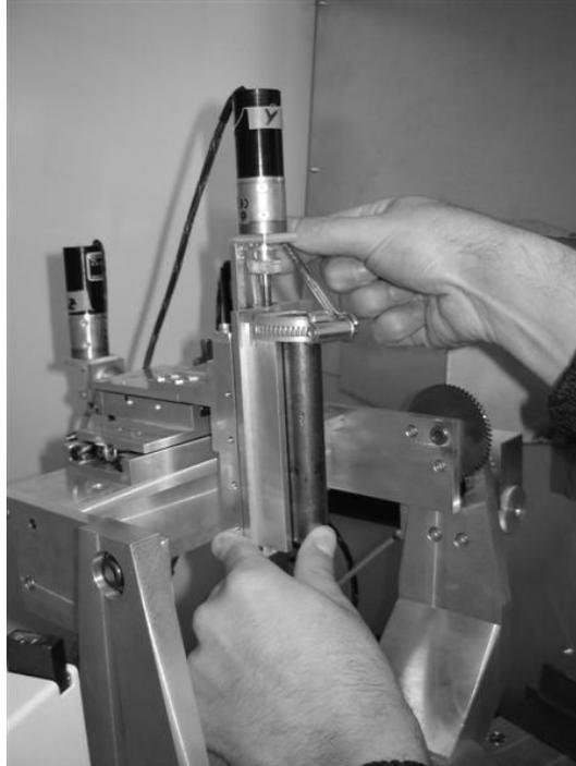
**Figura 4-5 - Fixação da amostra no equipamento de raios-X.**
