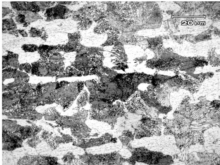
**Figura 5-5 - Barra trefilada, aspecto longitudinal da amostra caracterizando o sentido de trefilação, estrutura perlítica (região escura) e ferrita (região clara), ataque Nital 2%.**
