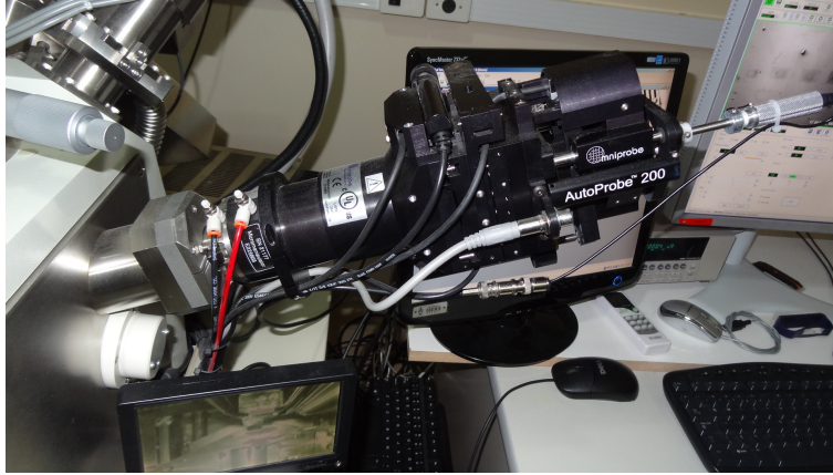
Fig. 2.8: Foto do nanomanipulador acoplado ao sistema duplo feixe do LCN.
