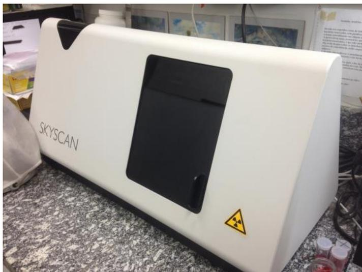
Figura 1: Aparelho de Micro-CT SkyScan® modelo 1174
