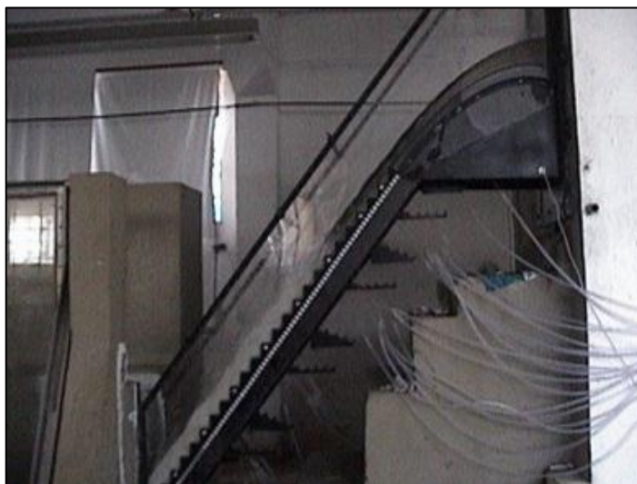
Figura 4.1 - Vista lateral do experimento de Sanagiotto (2003) com degraus de 6 centímetros de altura e vazão de 40 l/s.
