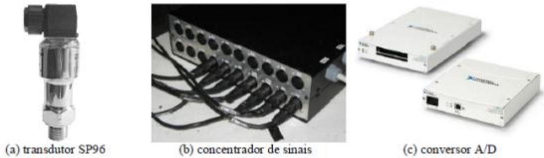
Figura 4.6 - Instrumentação dos degraus.
