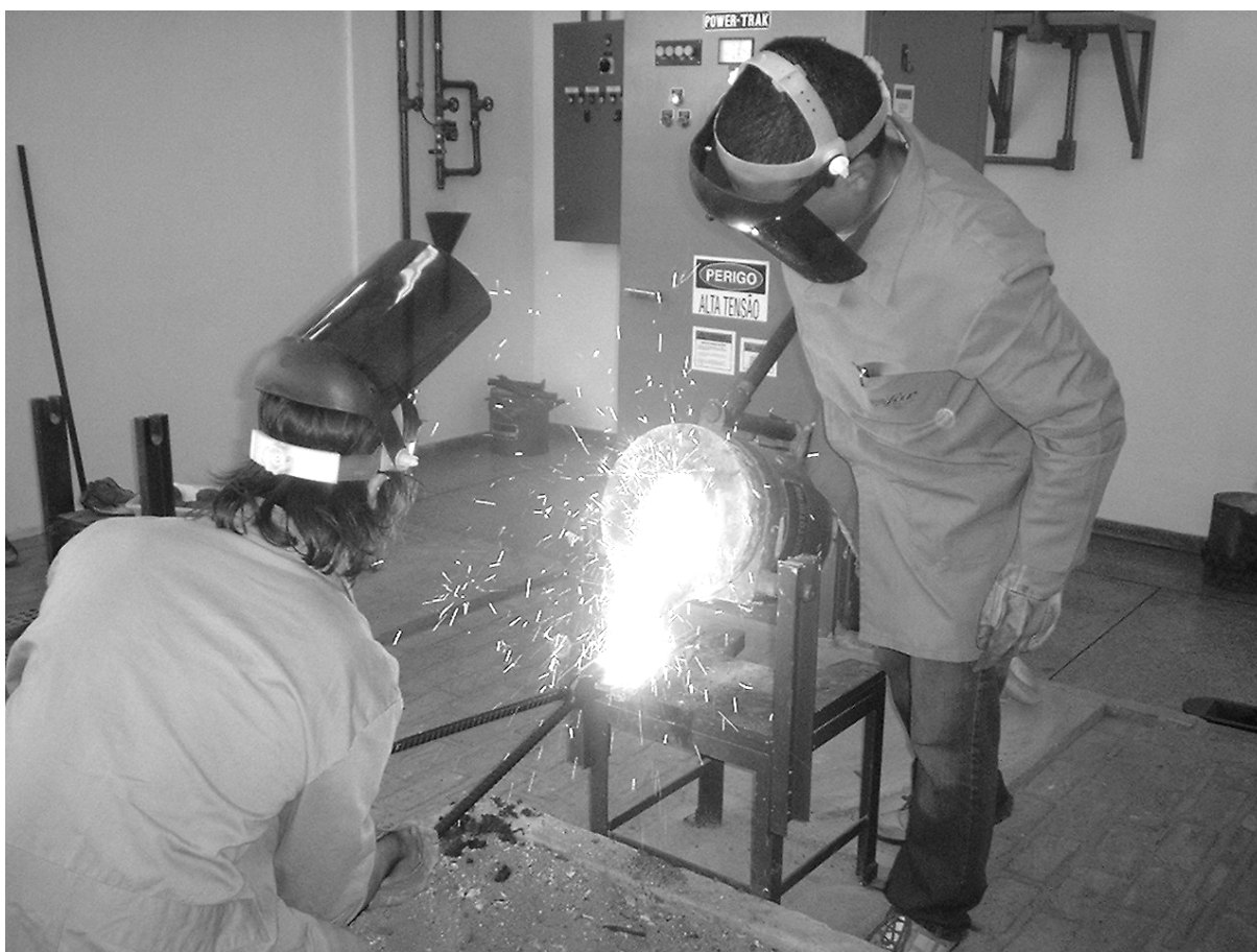
Figura 03. Transferência do metal líquido para a coquilha.
