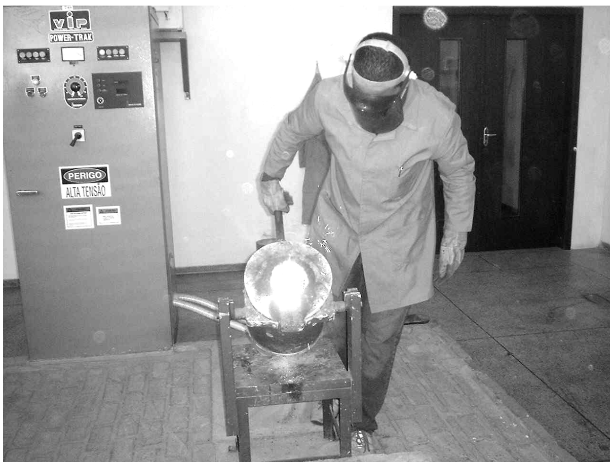
Figura 02. Forno utilizado para fusão e redução da carga
