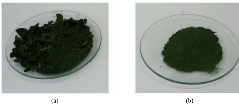
Figura 15. Fotografias das cinzas de incineração de aparas de couro (CIAC); (a) original; (b) após cominuição
