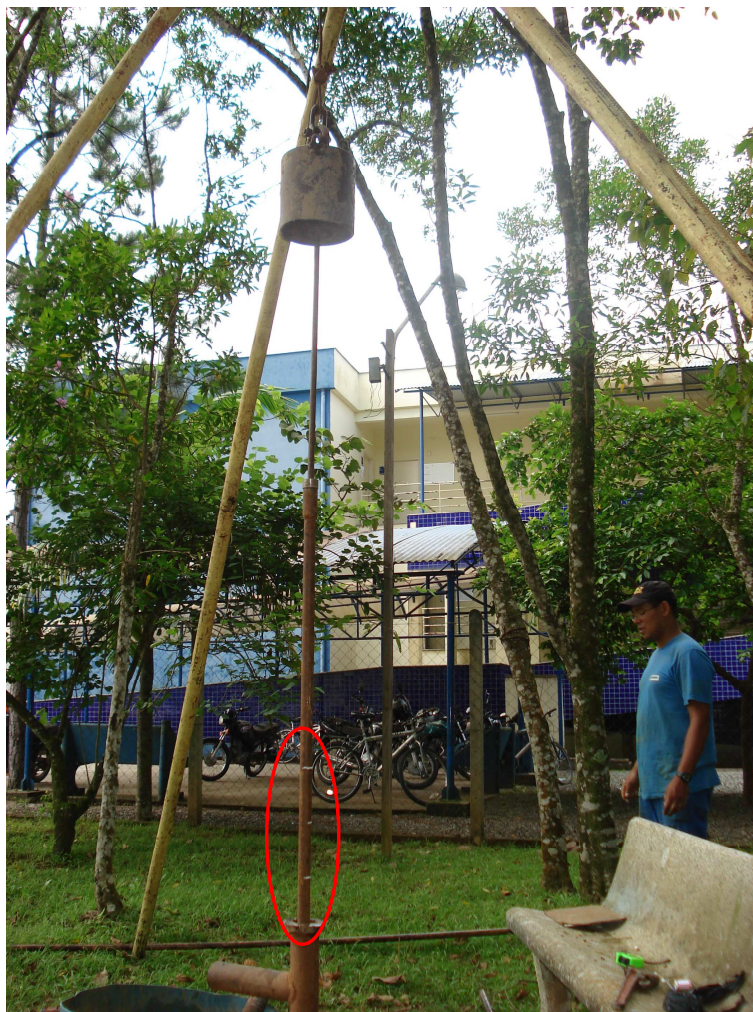
Figura 5.4: Marcação com giz, utilizada na determinação da penetração permanente de cada golpe.
