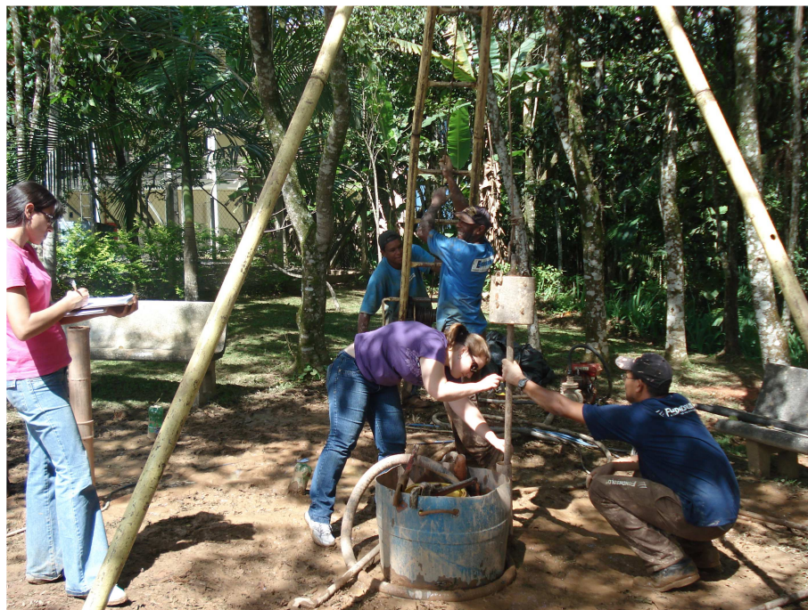
Figura 5.15: Registro, com o auxílio de giz e de uma fita métrica, da penetração permanente de cada golpe.
