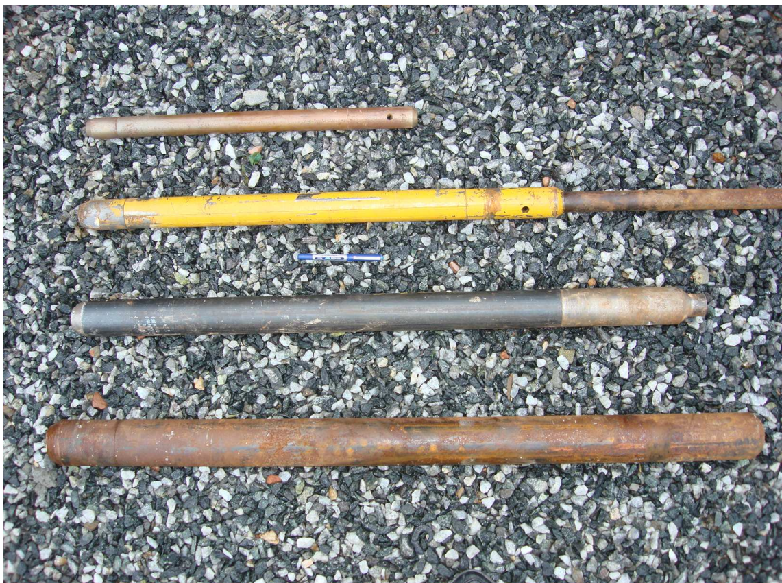
Figura 3.11: Cabeça, corpo e sapata cortante dos amostradores.
