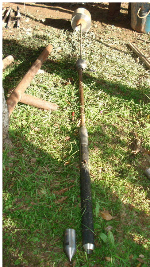
Figura 5.7: Composição do ensaio 1,5 SPT.
