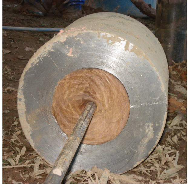
(b) detalhe do coxim de madeira.
