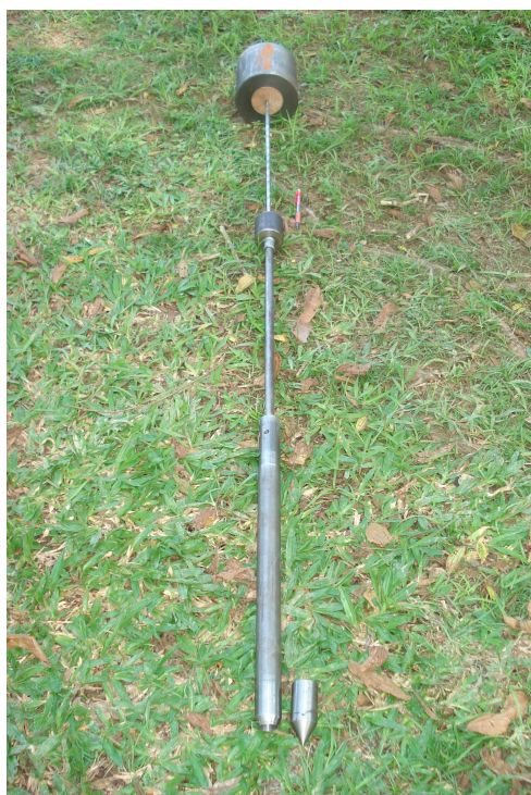
Figura 5.5: Composição do ensaio 0,5 SPT.
