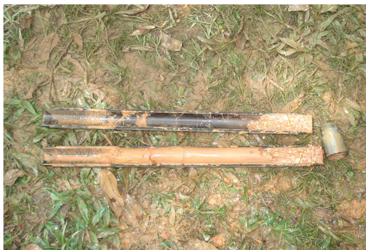
Figura 5.16: Amostrador-padrão com amostra de solo.
