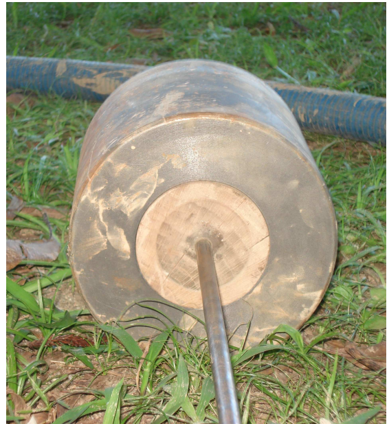
(b) detalhe do coxim de madeira.
