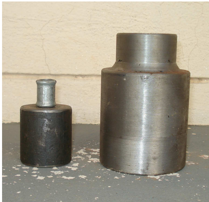
Figura 3.7: Cabeça de bater utilizada para os ensaios com o martelo de 23 kg e 120 kg, respectivamente.
