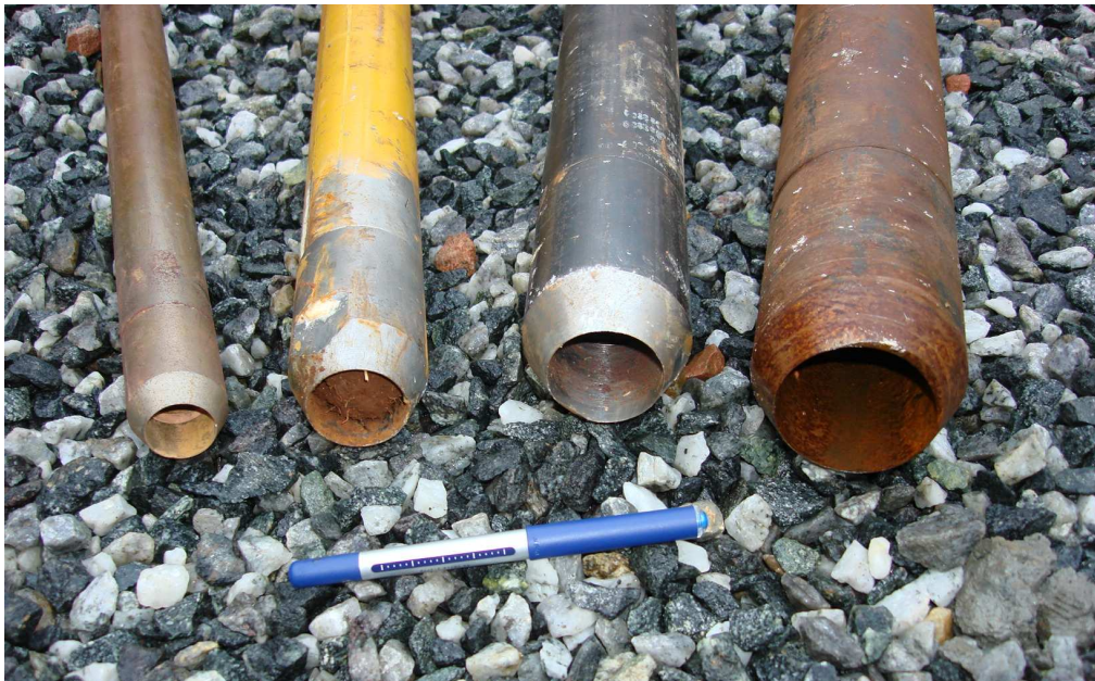
(b) detalhes das sapatas cortantes com ponta aberta.
