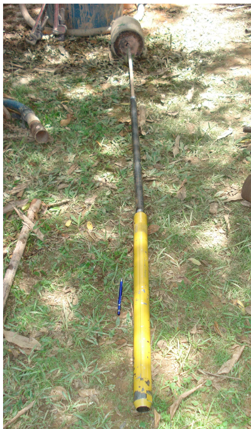
Figura 5.6: Composição do ensaio 1,0 SPT.
