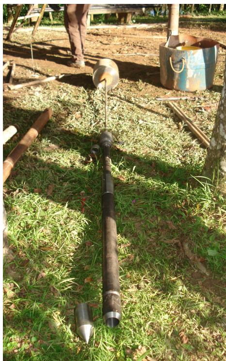
Figura 5.8: Composição do ensaio 2,0 SPT.
