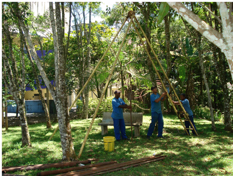
Figura 5.12: Equipamento utilizado na execução da sondagem.
