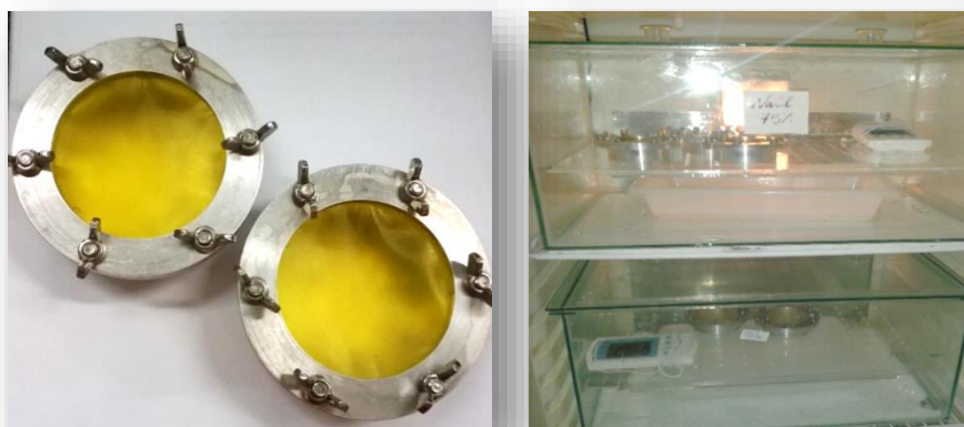
Figura 7: Cápsulas de permeabilidade com filmes (esquerda) e câmara de vidro usadas para análise de PVA dos filmes (direita).
