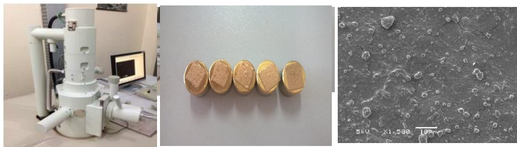
Figura 10: Microscópio eletrônico de varredura (direita); filmes colados em stubs metalizados com ouro (meio); exemplo de imagem obtida com aumento de 1500 x da superfície de um filme.
