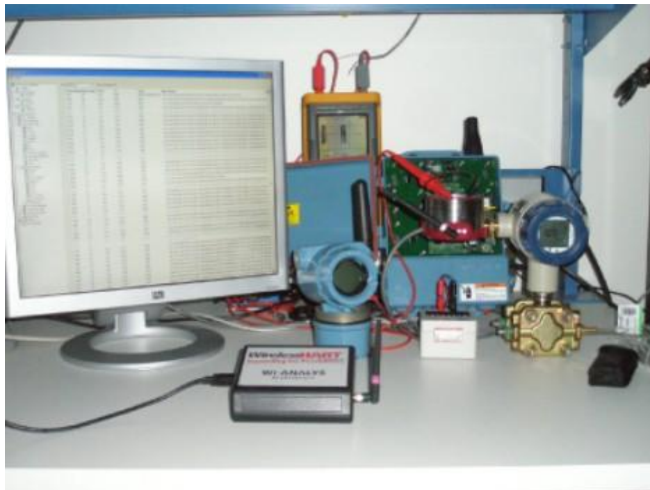
Figura 10 – Wi-Analys: captura tráfego da rede WirelessHART
