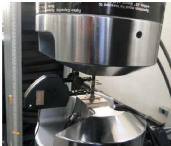
Figura 3-18 Posicionamento e fixação do corpo de prova no ensaio de Tração.
