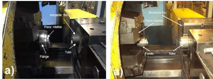
Figura 3-12 Disposição das peças na solda por fricção a) Flange e tubo b) Fundo e tubo
