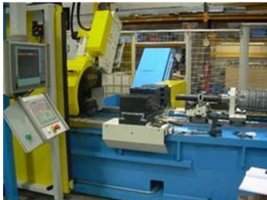
Figura 3-7 Máquina de soldagem por fricção Thompson - 125 toneladas
