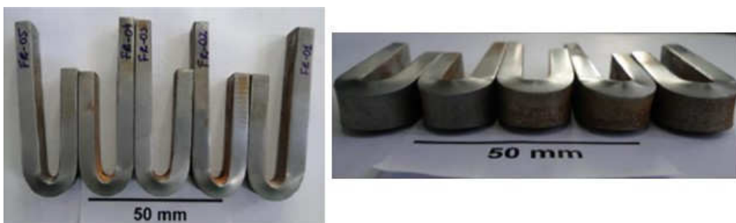
Figura 4-4 Ensaio de dobramento para os conjuntos soldados no processo fricção
