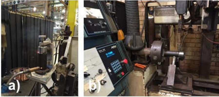
Figura 3-8 Soldagem MAG entre o fundo e o tubo a) Solda ponto b) Solda fechamento horizontal
