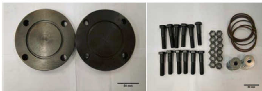
Figura 3-21 Dispositivos e peças utilizadas para o ensaio hidrostático
