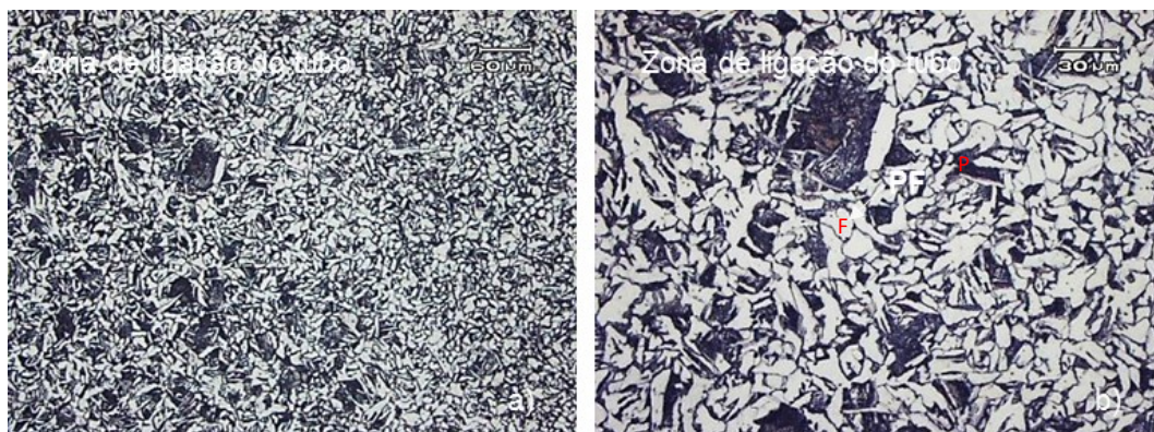
Figura 4-15 Micrografia da zona de ligação entre o tubo e o material de adição. Microestrutura formada por perlita (P) e ferrita (F) com tamanho de grão entre 9-10 (ASTM E112). a) 60 \mu m e b) 30 \mu m.
