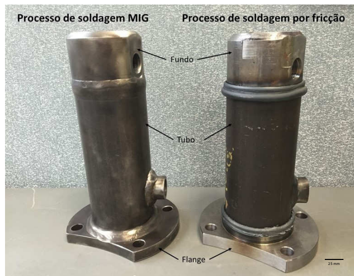
Figura 1-1 Conjunto camisa de cilindro hidráulico soldado nos processos MAG e fricção
