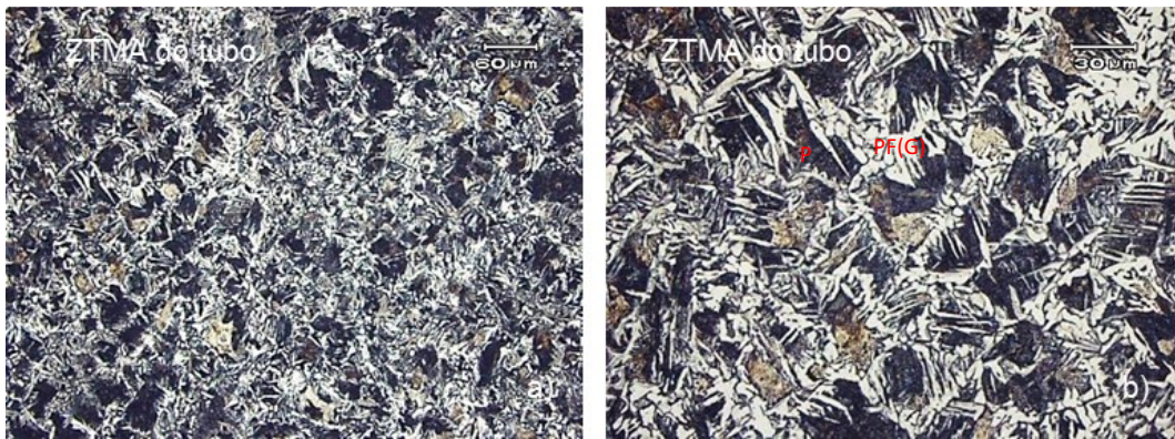
Figura 4-22 Micrografia da ZTMA do tubo composta de ferrita no contorno de grão (PF (G)) e perlita (P). Tamanho de grão entre 8-9 (ASTM E112). a) 60µm e b) 30µm.
