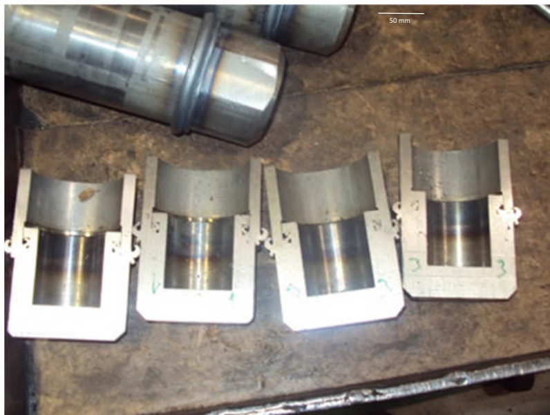
Figura 3-13 Análise macrográfica do cordão de solda durante os testes da solda do fundo
