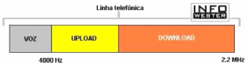
Figura 4.10: Utilização de banda no ADSL
