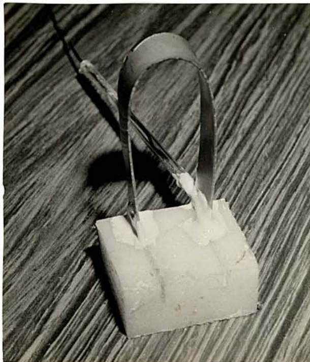
Fig.3 - Corpo de prova em forma de U .
