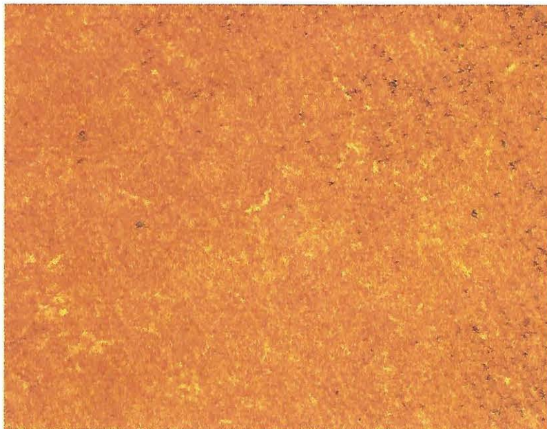
Figura 60 - Estrutura característica do aço SAE 1045 temperado e revenido. Martensita revenida. 500X.Nital 10%.
