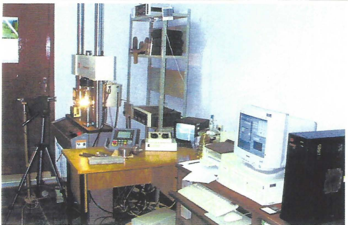
Figura 49 - Câmera CCD focada na propagação da trinca e lançando imagem no monitor.
