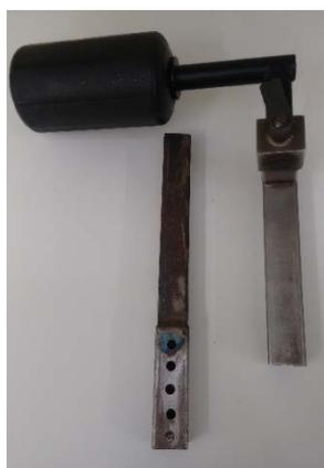
**Figura 2.** Suporte adaptado para o dinamômetro isocinético para apoio da coxa.
