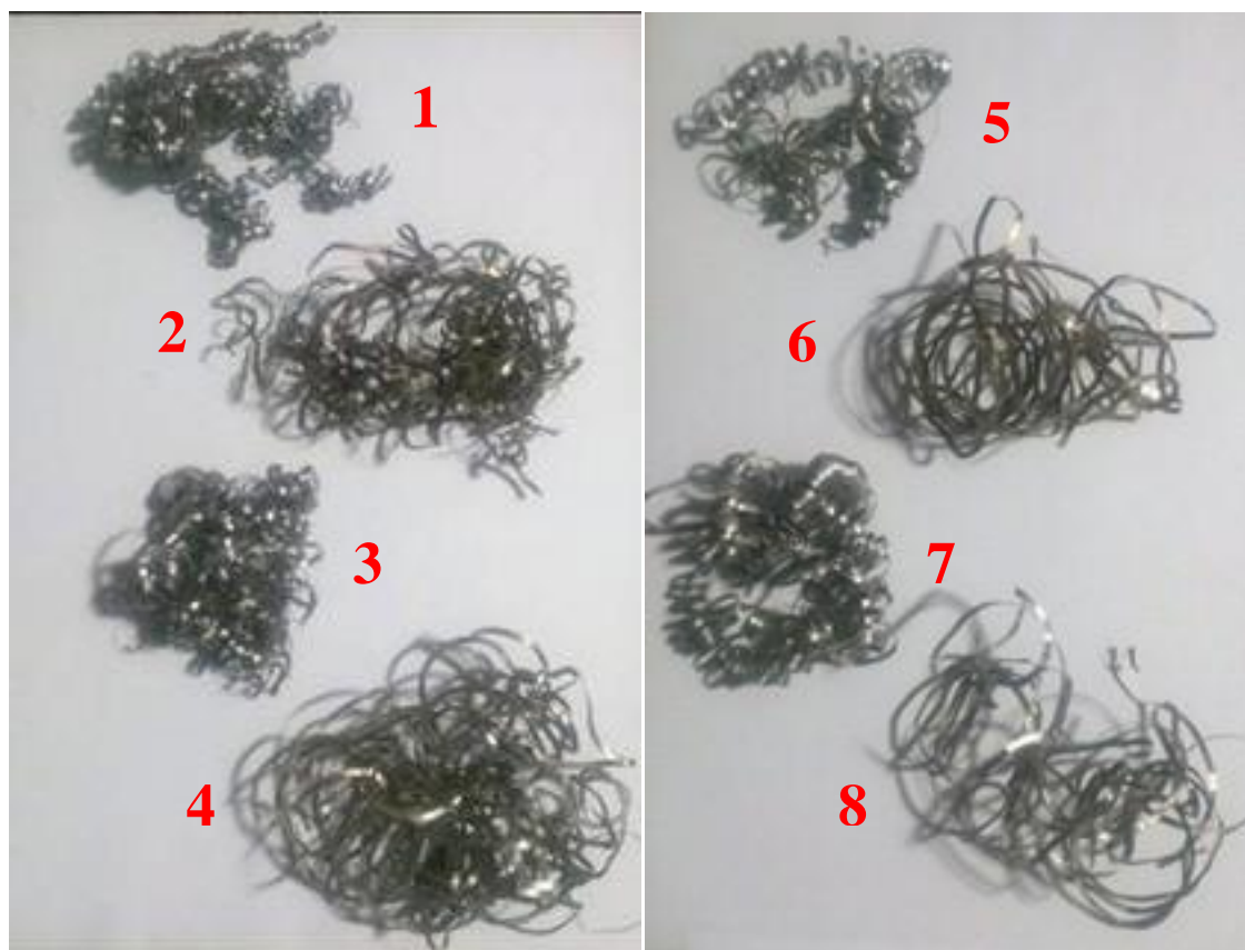
Figura A1 – Cavacos formados e numerados conforme todas as combinações dos parâmetros: 1), 3), 5), e 7) Cavaco contínuo tubular emaranhado; 2), 4), 6), e 8) Cavaco contínuo em fita emaranhado.
