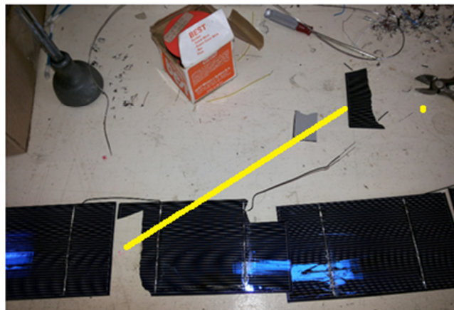
Figura 33 : Quebra de células no agrupamento para colocação na calha fotovoltaica
