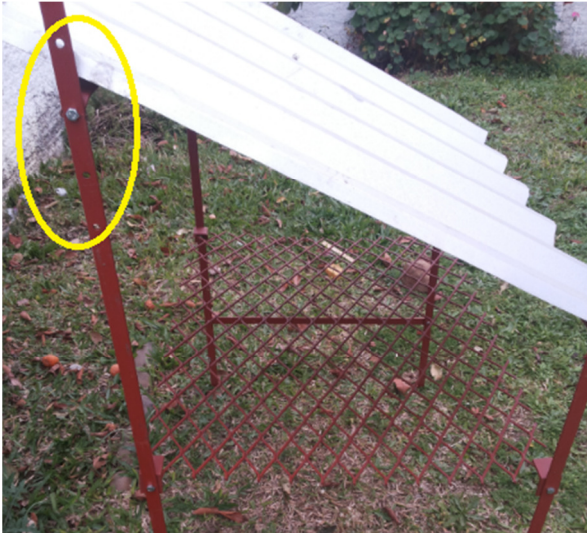
Figura 24 : Furos de regulagem de angulação para radiação solar
