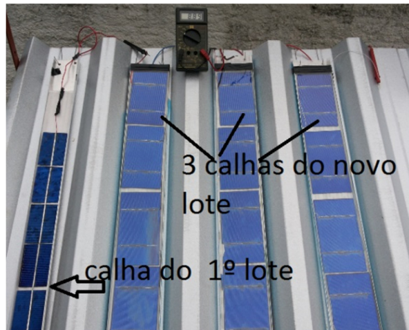
Figura 35 : Junção de 1 calha com células 1ºlote e 3 calhas no lote novo
