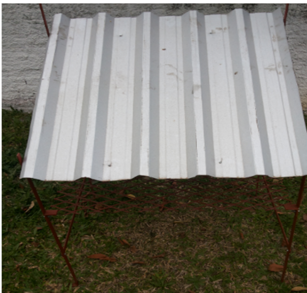
Figura 22 : Estrutura de aço com telha de Zinco
