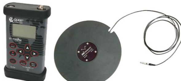
Figura 3.1 - Medidor VI400-Pro e seatpad utilizados nas medições.
