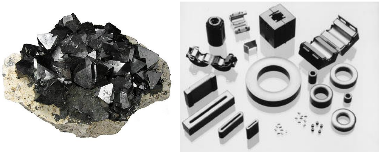
Figura 3.1. À esquerda, magnetita ( \text{Fe}_3\text{O}_4 ) em sua forma encontrada na natureza. À direita, dispositivos magnéticos feitos a partir deste material. Adaptados de 3 .
